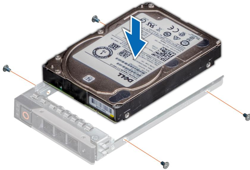
**Ilustración 38. Instalación de una unidad en el portaunidades**
