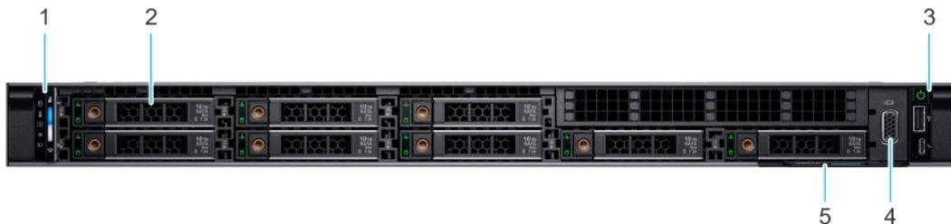
**Ilustración 2. Vista frontal del sistema de unidad de 8 x 2,5 pulgadas**
