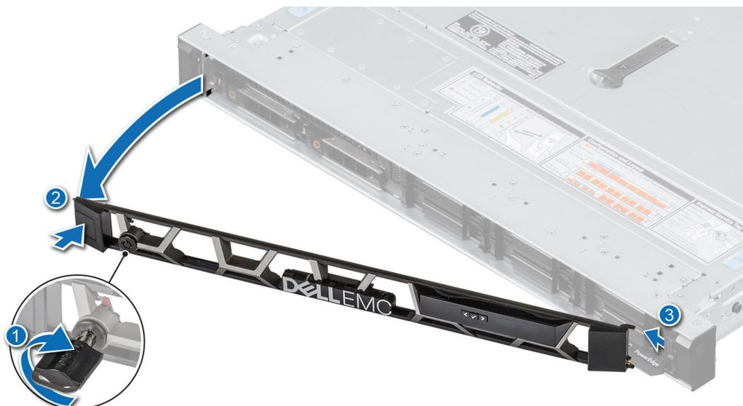
**Ilustración 15. Extracción del bisel frontal**
