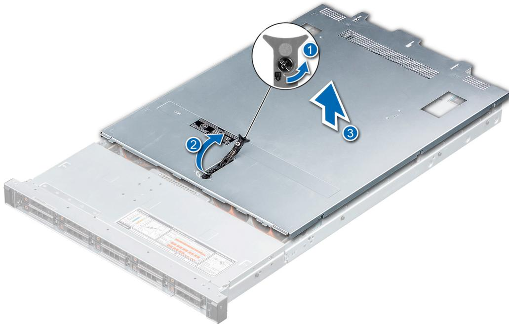
**Ilustración 17. Extracción de la cubierta del sistema**
