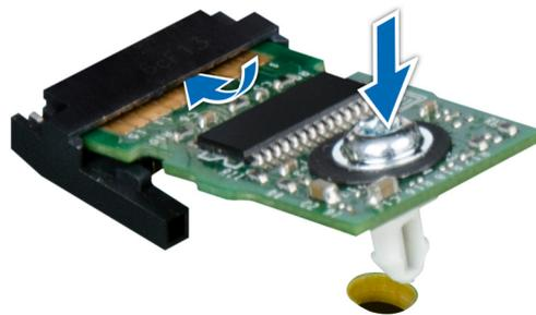
Ilustración 128. Instalación del TPM
