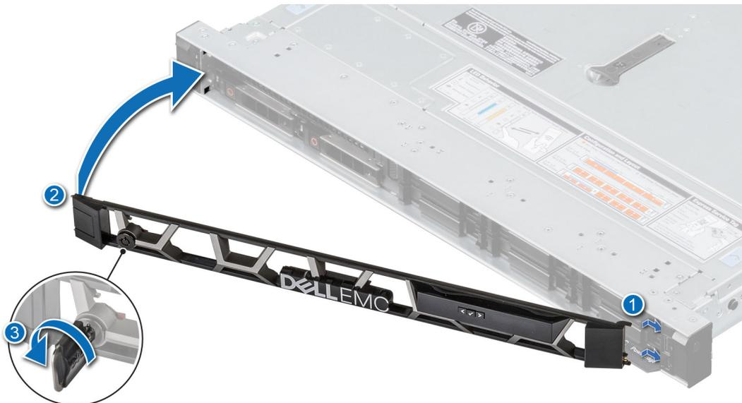
Ilustración 16. Instalación del bisel frontal
