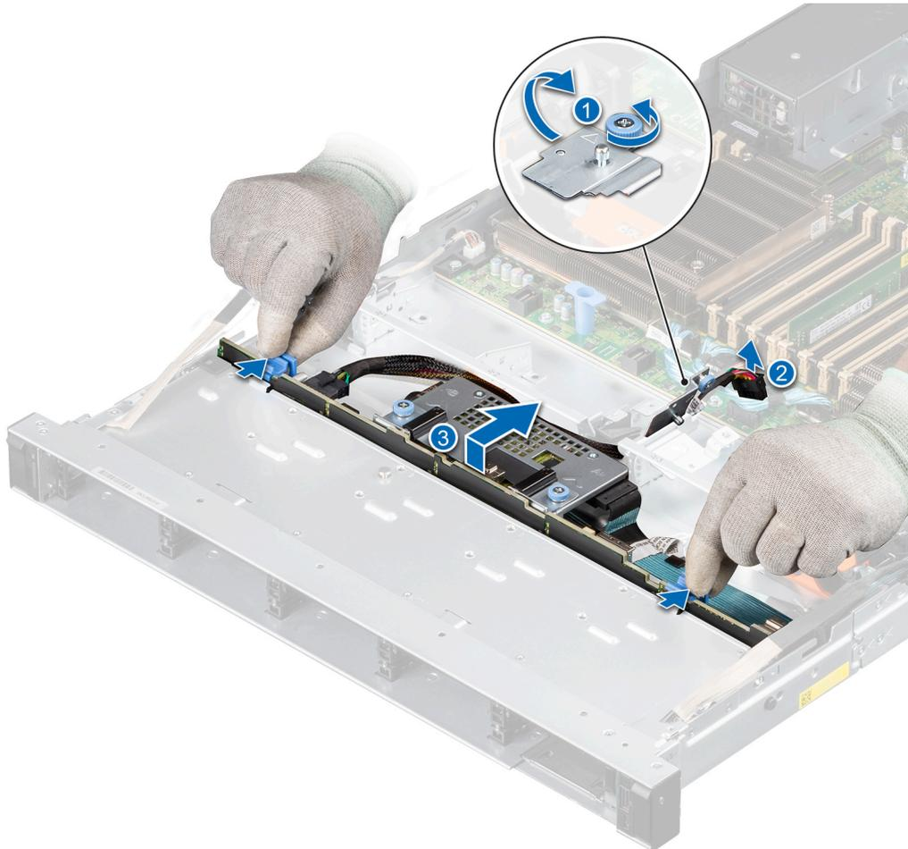
**Ilustración 42. Extracción del backplane de la unidad**
