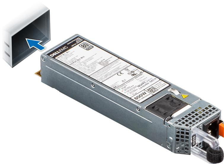
**Ilustración 127. Instalación de una fuente de alimentación**
