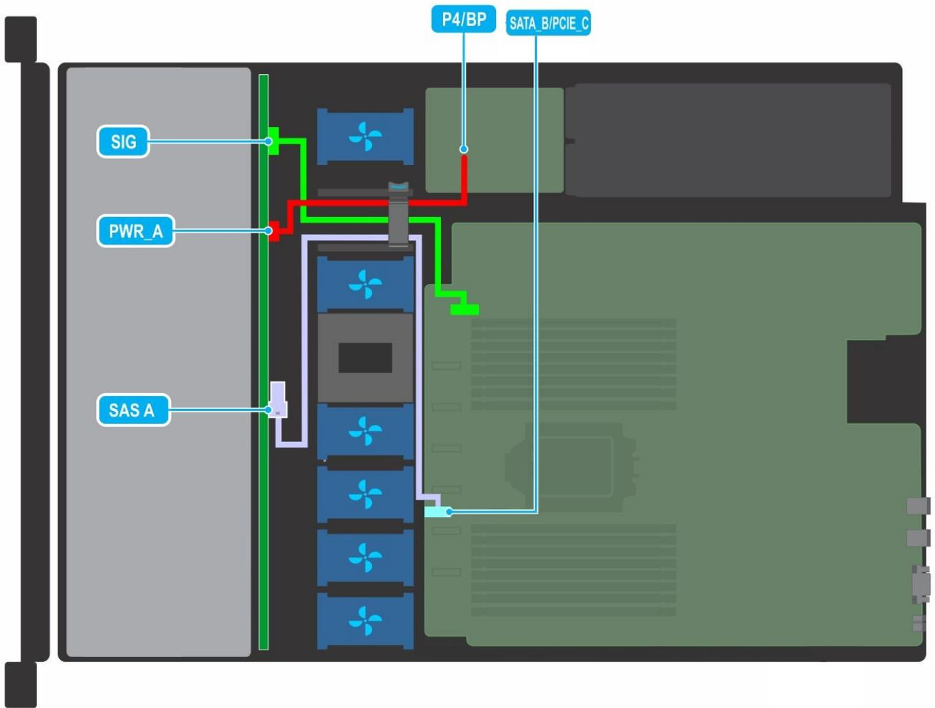
Ilustración 1. Colocación de los cables: backplane de unidad SATA de 4 x 3,5 pulgadas
