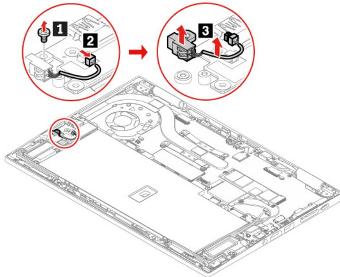
6. Installare un nuovo carica batterie della penna **1**. Installare la vite per fissare il carica batterie della penna **2** e collegare il connettore **3**.
