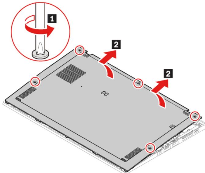
5. Installare il nuovo assieme del coperchio della base **1** **2**. Accertarsi che i fermi dell'assieme del coperchio di base siano fissati sotto l'assieme del coperchio di base. Quindi, stringere le viti in ordine alfabetico crescente (da "a" a "e") per fissare l'assieme del coperchio della base **3**.
