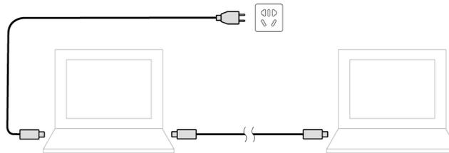
**Nota:** La velocità di caricamento effettiva utilizzando la funzione di carica P-to-P 2.0 esclusiva di Lenovo varia a seconda di molti fattori, come la carica residua della batteria dei computer, il wattaggio dell'adattatore di alimentazione CA e se si utilizza il computer.
