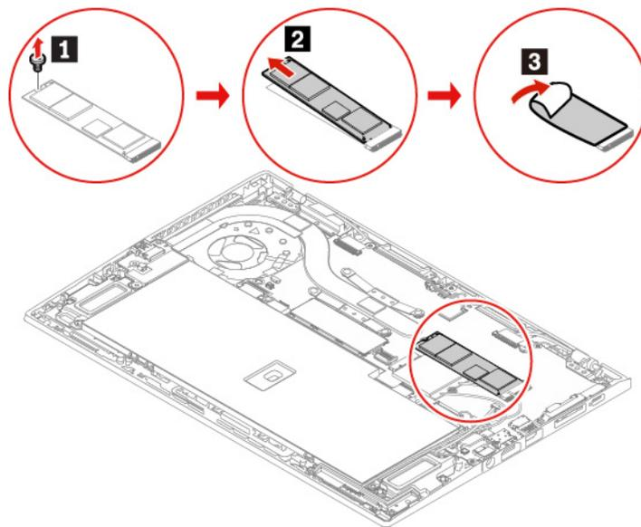
6. Installare una nuova unità SSD M.2 e un nuovo pad termico:
