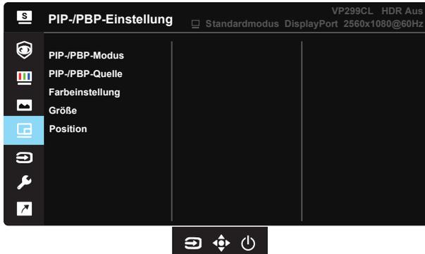
Durch Aktivierung dieser Funktion zeigt der Monitor zwei Bilder von zwei verschiedenen Videoquellen an.
