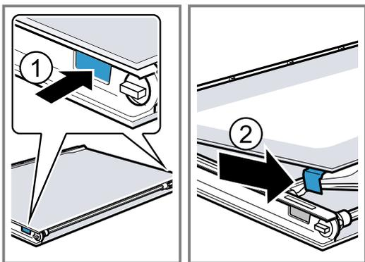
4. Appuyez vers le bas sur la vitre intermédiaire dans la zone [a] soulevez avec précaution la fixation [b] jusqu'à ce qu'elle puisse être retirée.
