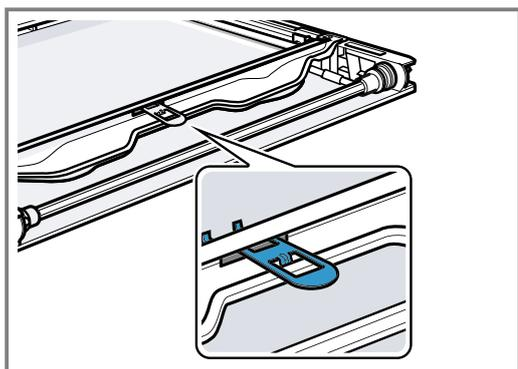
3. Insérez la vitre intérieure de biais vers l'arrière dans le rail de fixation [a] ①.
