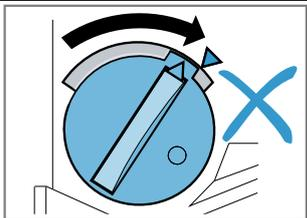
Dispositivo di bloccaggio sul lato sinistro fissato
