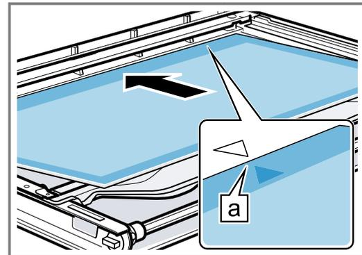
La freccia sul pannello intermedio deve coincidere con la freccia sulla cornice **a**.
