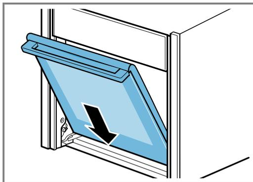
3. Allentare i due dispositivi di arresto dello sportello dell'apparecchio servendosi di una moneta. Infilare la moneta nella fessura del dispositivo di arresto ① e ruotare il dispositivo di bloccaggio fino allo scatto ②.
