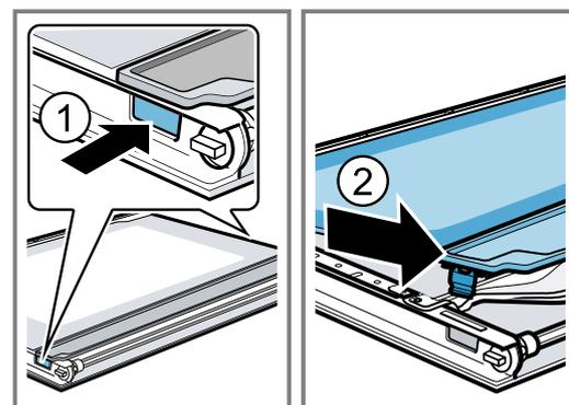
4. Appuyer vers le bas sur la vitre intermédiaire dans la zone [a] et soulever avec précaution la fixation [b] jusqu'à ce qu'elle puisse être retirée.
