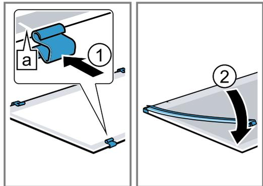
3. Placer la vitre intermédiaire avec les joints et les écarteurs dans le sens de la flèche ①. La flèche sur la vitre intermédiaire doit correspondre avec celle du cadre [a].
