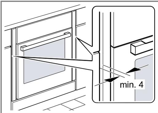
Une fente d'aération d'au moins 4 mm est nécessaire entre l'appareil et la façade des meubles adjacents.
