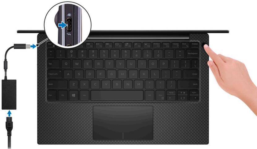
**ANMERKUNG:** Der Akku kann während des Versands in den Energiesparmodus wechseln, um den Akku nicht zu entladen. Stellen Sie sicher, dass der Netzadapter an den Computer angeschlossen ist, wenn er zum ersten Mal eingeschaltet wird.
