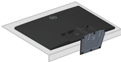
2. Pressione o botão de desenganche utilizando uma chave de fendas comprida.
