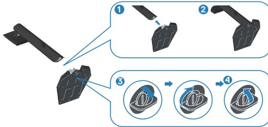
5. Deslice las pestañas del pedestal de montaje en las ranuras del monitor y presione el conjunto del pedestal hacia abajo para colocarlo en su sitio.
