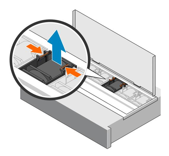
Figure 114. Removing a fan module
