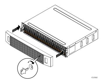
Figure 22. Installing the bezel
