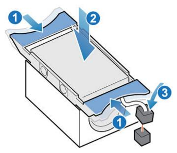
Figure 75. Installing the fan module
