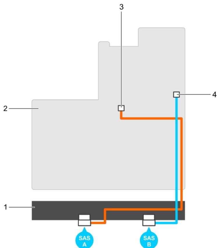
**Ilustración 1. Cableado de la controladora S140**
