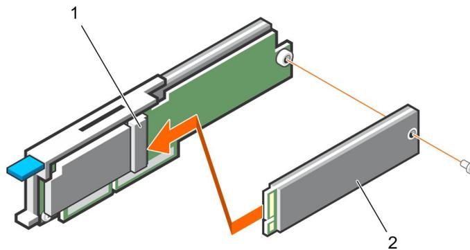
**Ilustración 8. Instalación del módulo SSD M.2 en la tarjeta modular BOSS-S1**
