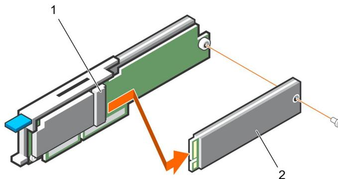
**Ilustración 6. Extracción del módulo SSD M.2 de la tarjeta modular BOSS-S1**
