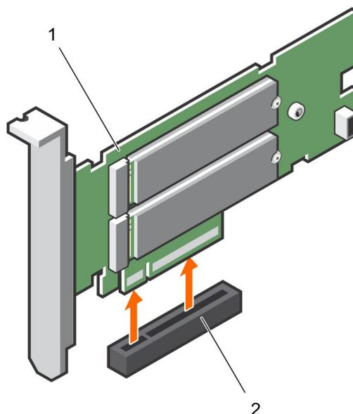
**Ilustración 3. Extracción de la tarjeta adaptadora BOSS-S1**
