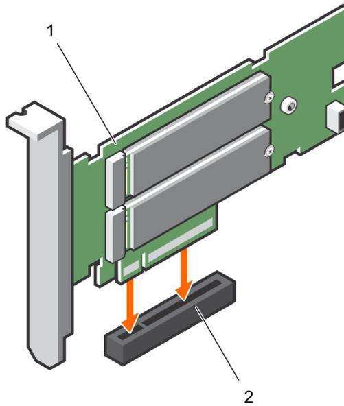
**Ilustración 9. Instalación de la tarjeta adaptadora BOSS-S1**
