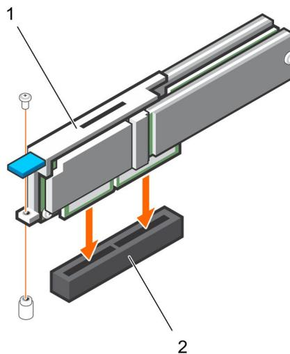
**Ilustración 10. Instalación de la tarjeta modular BOSS-S1**
