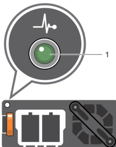
**Figura 5. Indicador de estado de la PSU de CC**
