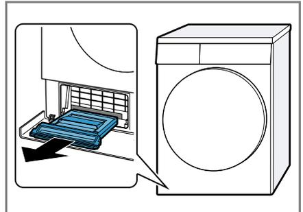
Il vano di deposito della lanugine può contenere acqua di condensa e può gocciolare durante l'estrazione.
