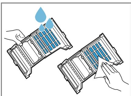
È possibile rimuovere lo sporco più ostinato utilizzando una spazzola morbida. Non danneggiare o rimuovere la guarnizione del vano di deposito della lanugine. Il vano di deposito della guarnizione può essere lavato anche in lavastoviglie.
