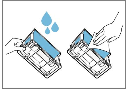
È possibile rimuovere lo sporco più ostinato utilizzando una spazzola morbida. Accertarsi di asciugare bene il filtro. Un filtro umido può prolungare il tempo di asciugatura e influenzare il risultato di asciugatura.
