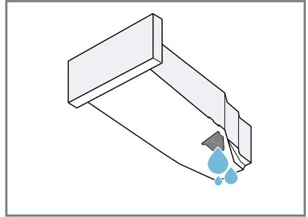
Controllare regolarmente il filtro del contenitore dell'acqua di condensa → *Pagina 48* e pulire un filtro sporco.
