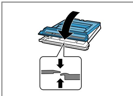
8. Inserire il vano di deposito della lanugine mantenendolo orizzontale finché non si innesta in posizione.
