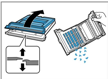
6. Pulire a fondo il filtro sotto l'acqua corrente e asciugarlo.
