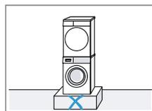
Installare questo apparecchio in una colonna lavatrice-asciugatrice soltanto con il set di collegamento originale del produttore dell'asciugatrice.
