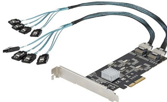
Questo controller SATA III (6 Gbps) a 8 porte consente di aggiungere otto dischi rigidi (HDD) SATA o unità a stato solido (SSD) a 6 Gbps a un computer o a un server tramite uno slot per schede PCIe x4. La scheda supporta le specifiche SATA III e PCI Express Gen 2 e quattro controller SATA per una soluzione di archiviazione dei dati ad alte prestazioni.
