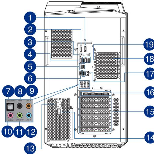
**1** DisplayPort. Dieser Anschluss ist für DisplayPort-kompatible Geräte.
