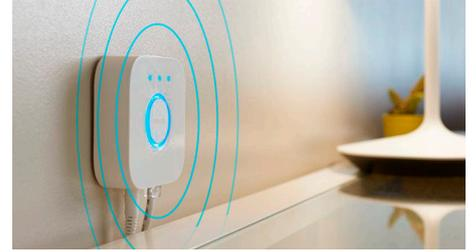
El Hue Bridge es un componente esencial de un sistema de iluminación inteligente personal de Philips Hue. Es el cerebro del sistema que se comunica con las lámparas inteligentes y la app Hue para garantizar que todo funcione conjuntamente. También permite funciones de automatización de hogar inteligente tales como temporizadores y rutinas de programación.
