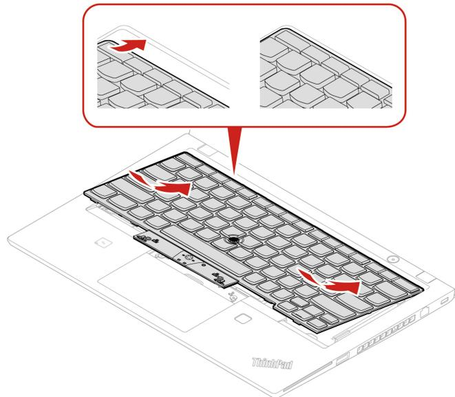
3. Far scorrere la tastiera nella direzione delle frecce. Verificare che i fermi siano fissati sotto alla struttura della tastiera.
