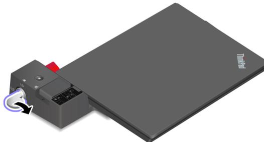
**Attenzione:** quando il computer è collegato a una docking station, mantenere sempre l'intero assieme quando è necessario spostare il computer. Altrimenti, la docking station potrebbe cadere.
