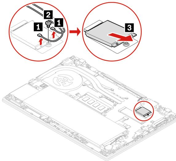
**Nota:** Dopo l'installazione, verificare di aver collegato il cavo arancione al connettore con etichetta Orange sulla scheda e il cavo blu al connettore con etichetta Blue.
