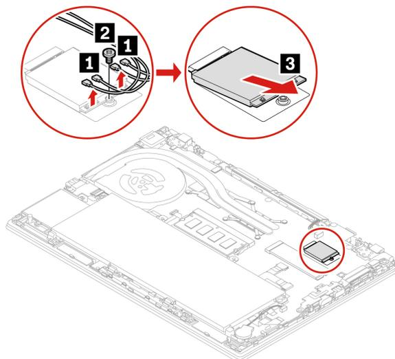
**Nota:** Dopo l'installazione, verificare di aver collegato il cavo arancione al connettore con etichetta Orange sulla scheda, il cavo blu al connettore con etichetta Blue, il cavo bianco e grigio al connettore M1 e il cavo nero e grigio al connettore M2.
