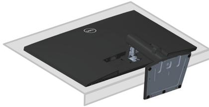
2. Desatornille completamente el tornillo de mariposa del soporte de inclinación.
