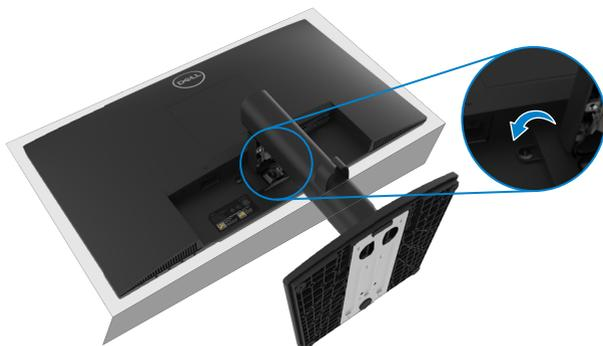
2. Deslize o suporte para o retirar completamente do monitor.
