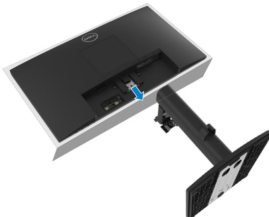
3. Pressionar a lingueta de desengate rápido na parte inferior da base para separar a base da coluna do suporte.
