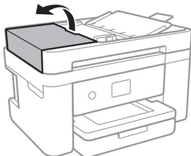
2. Pulire il rullo e la parte interna dell'ADF con un panno morbido e umido.
