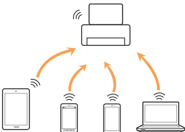
La stampante può venire simultaneamente connessa tramite Wi-Fi o Ethernet e in modalità Wi-Fi Direct (AP semplice). Tuttavia, se si inizia una connessione di rete in modalità Wi-Fi Direct (AP semplice) quando la stampante è connessa tramite Wi-Fi, la connessione Wi-Fi viene temporaneamente disconnessa.
