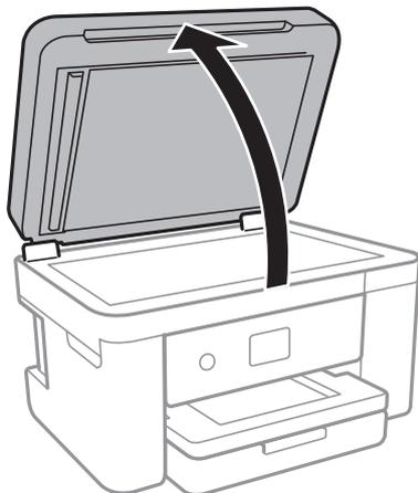
2. Pulire la superficie del vetro dello scanner con un panno morbido, asciutto e pulito.
