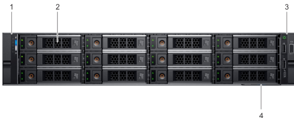
Ilustración 2. Vista frontal del sistema de unidad de 12 x 3,5 pulgadas
