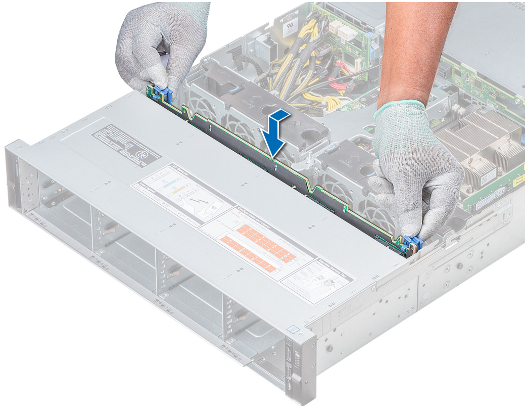
Ilustración 101. Instalación del plano posterior
