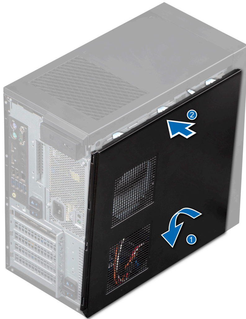
Figure 11. Installation du capot du système
