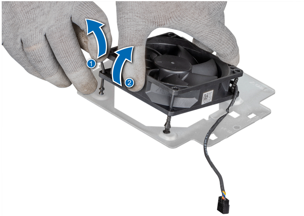
Figure 38. Retrait du ventilateur système
