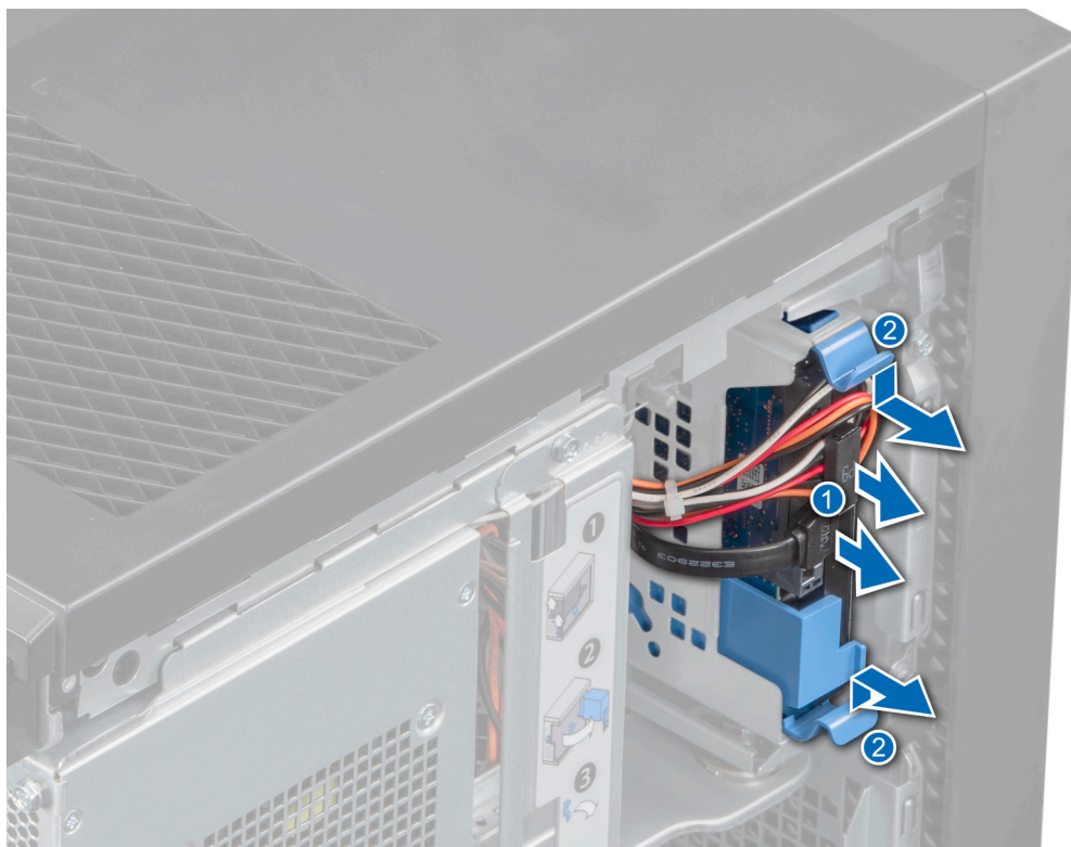
Figure 14. Retrait du support de disque dur
