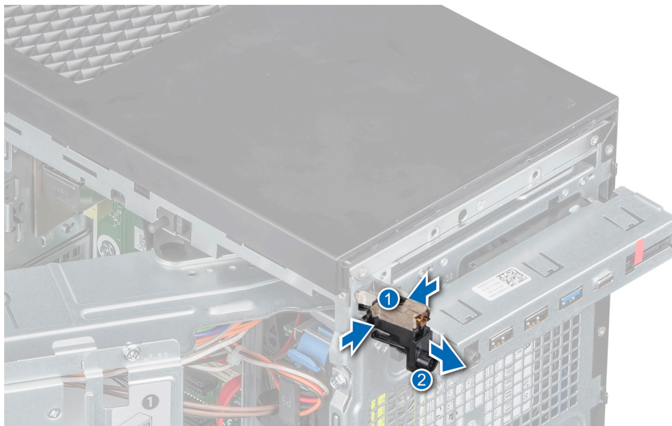
Figure 54. Retrait du module du bouton d'alimentation
