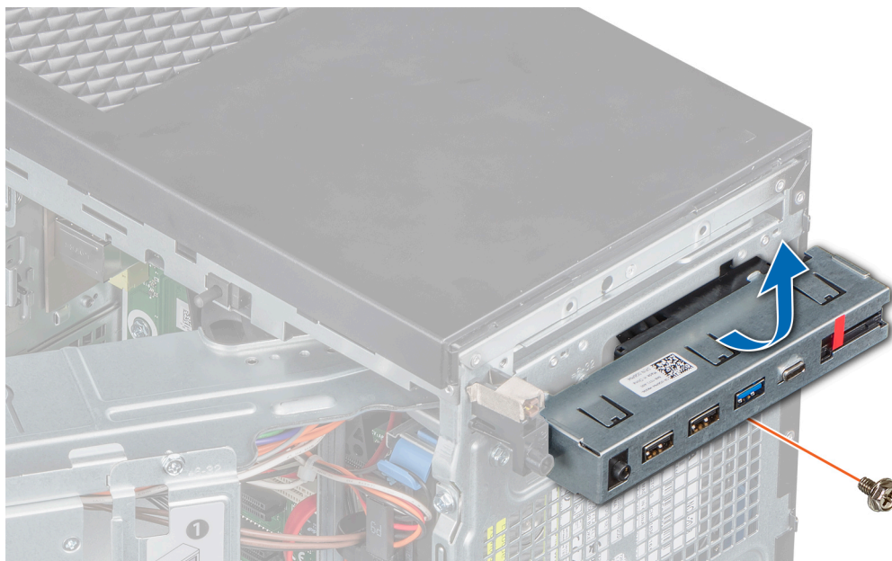
Figure 52. Retrait du panneau de commandes
