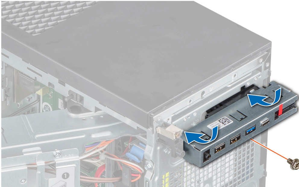
Figure 53. Installation du panneau de commande
