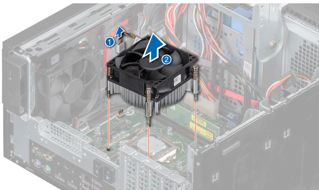
Figure 43. Retrait du dissipateur de chaleur
