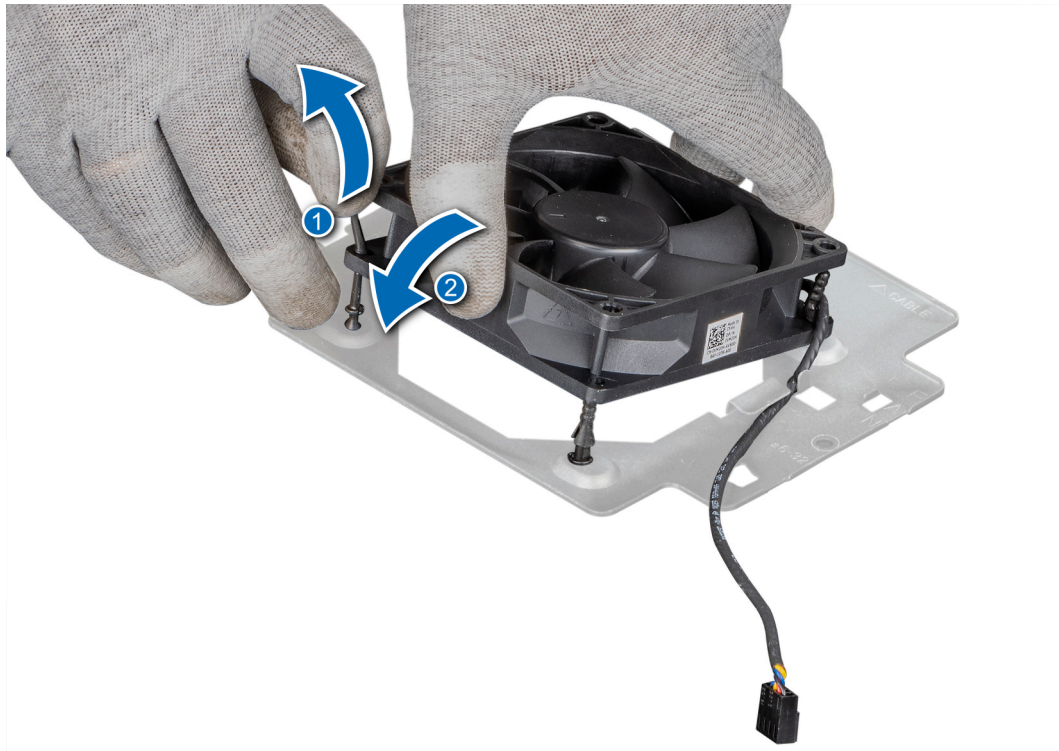
Figure 39. Installation du ventilateur système
