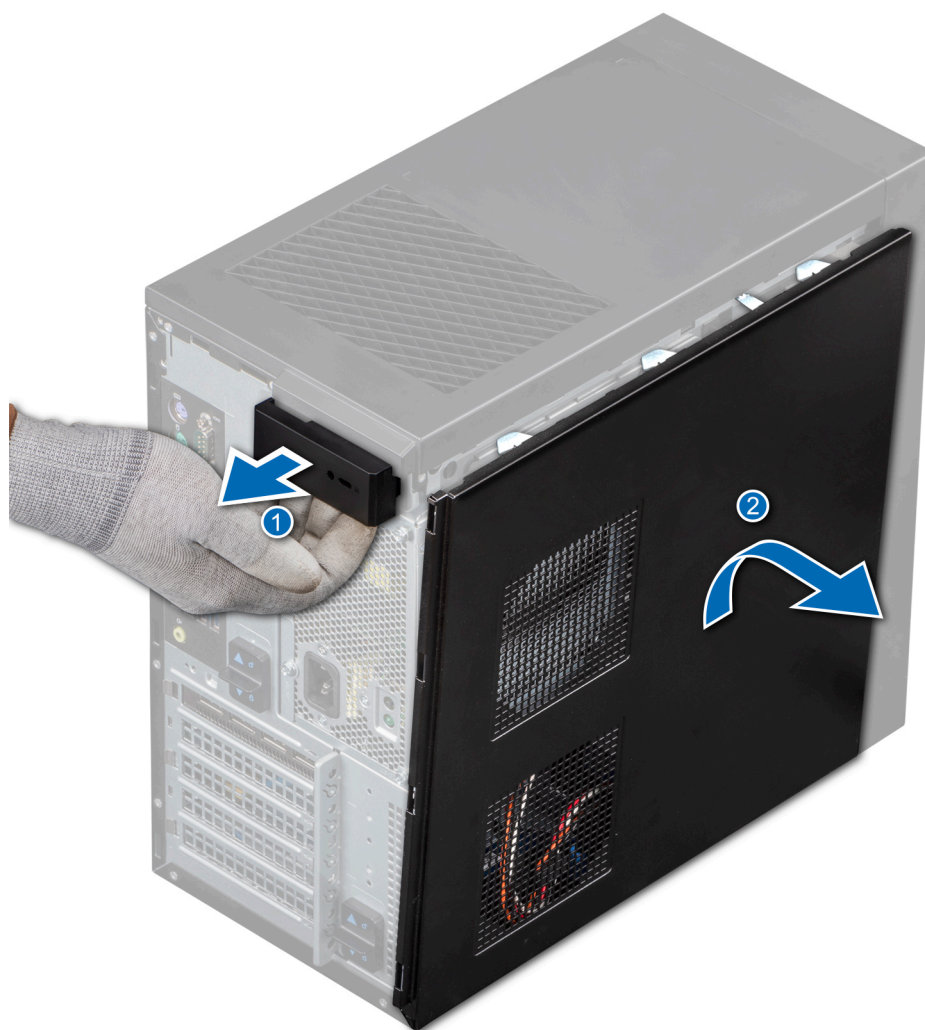
Figure 10. Retrait du capot du système
