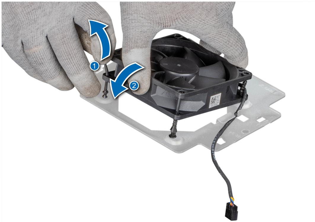
**Abbildung 39. Installieren des Systemlüfters**
