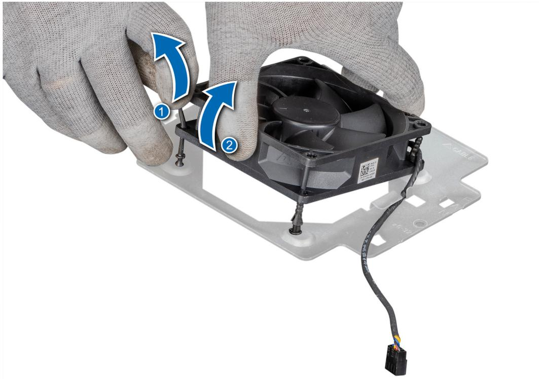
Abbildung 38. Entfernen des Systemlüfters
