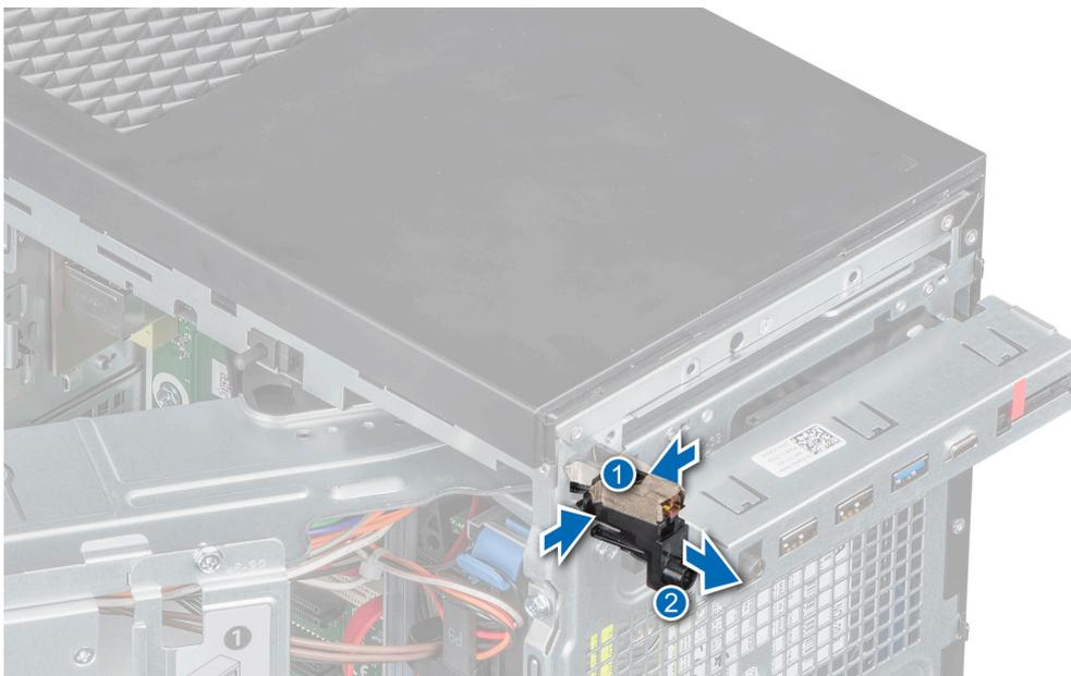
Abbildung 54. Entfernen des Betriebsschaltermoduls
