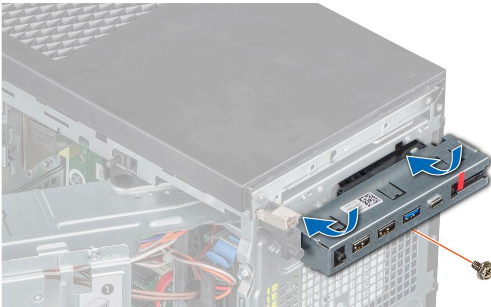
Abbildung 53. Installieren des Bedienfelds
