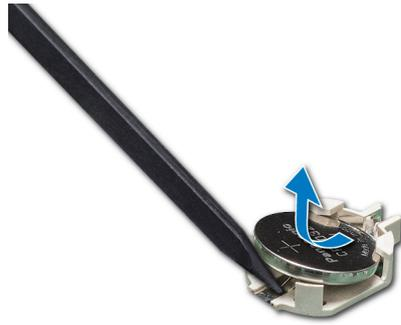
Abbildung 29. Entfernen der Systembatterie
