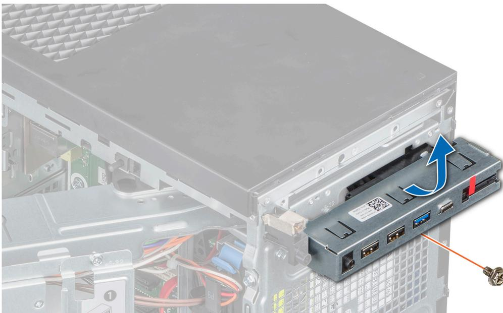
Abbildung 52. Entfernen des Bedienfelds
