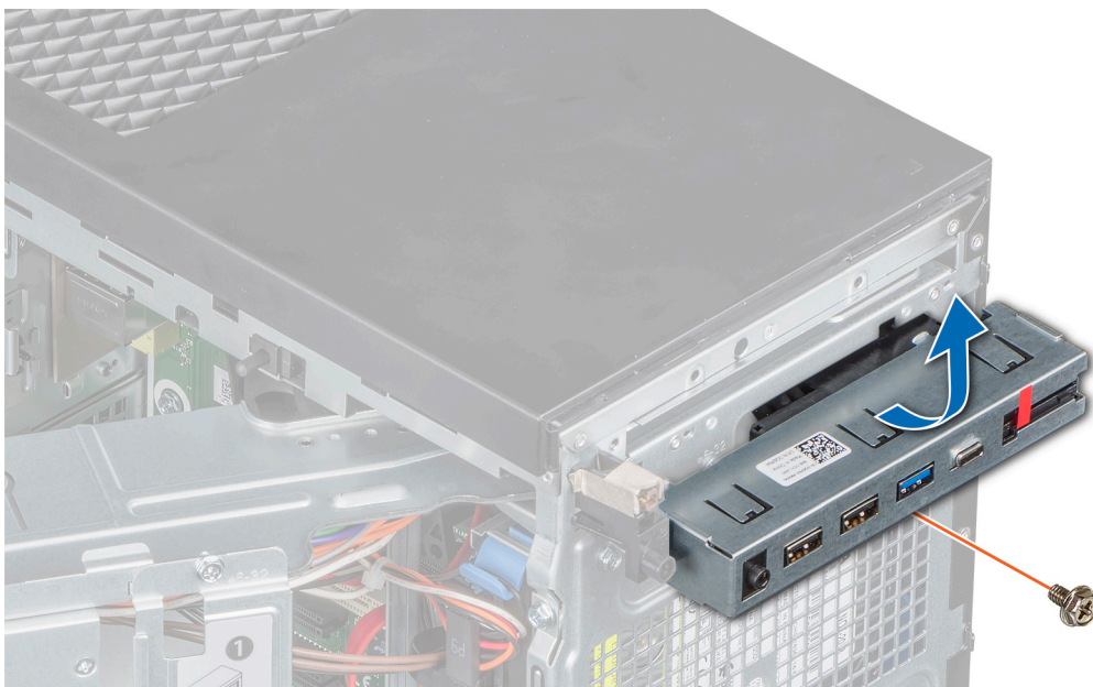
Abbildung 52. Entfernen des Bedienfelds
