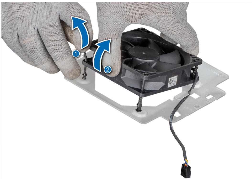
Figure 38. Retrait du ventilateur système
