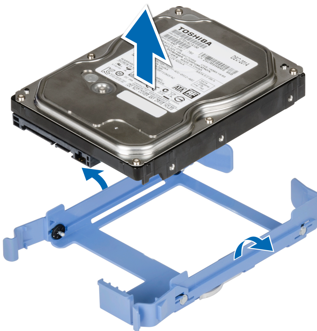
Figure 16. Retrait d'un disque dur installé de son support
