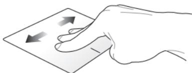
Si plusieurs applications sont ouvertes, faites glisser trois doigts vers la gauche ou la droite pour basculer d'une application à l'autre.
