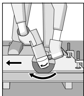
เมื่อถึงการตัดลับรอบบนออกแบบท่อสีเหลี่ยม ขอแนะนำให้เริ่ม ตรงจุดที่มีหนาตัดที่เล็กที่สุด
