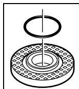
在固定法蘭 8 的定心軸環上有一個塑料零件（O 形環）。如果缺少 O 形環或 O 形環損壞了，務必在繼續使用之前更換固定法蘭 8。
