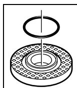
在固定法兰 8 的定心轴环上有一个塑料零件 (O 形环)。如果缺少 O 形环或 O 形环损坏了，务必在继续使用之前更换固定法兰 8。
