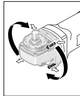
Đầu máy có thể xoay được đối với vỏ máy ở vào 90° nắc. Bằng cách này, công tắc Tắt/Mở có thể mang lại vị trí thuận lợi hơn đối với các tình huống gia công đặt biệt, vd., gia công cắt có sử dụng đường cắt có chắn bảo vệ việc hút bụi 21 hay cho người thuận tay trái.
