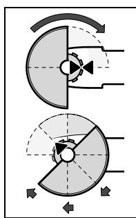
参考插图把防护罩 12 安装在主轴颈上。防护罩上的三角形记号,必须和机器传动头上的三角形记号相对。
