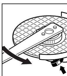
如果安装正确，而且快速螺母未损坏的话，一般可以用手朝著逆时针方向轻松快速螺母。
