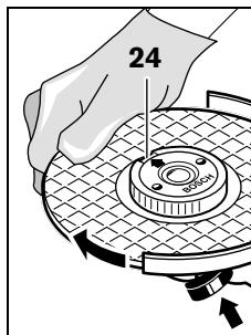
使用主轴锁定键 2 固定主轴。然后朝著顺时针的方向用力地转动砂轮，以便拧紧快速螺母。
