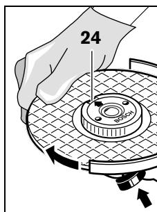
使用主軸鎖定鍵 2 固定主軸。然後朝著順時針的方向用力地轉動砂輪，以便擰緊快速螺母。
