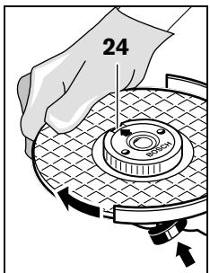
Khóa trực máy mài bằng nút khóa trực máy 2. Để siết chặt dài ốc khóa nhanh, xoay thật chặt đĩa mài theo chiều đồng hồ.
