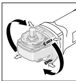
機器操作者可根據需要分段式轉動機頭，每一段的旋轉角度為 90 度。此功能的優點是能夠在特殊的工作狀況下，把起停開關移動到比較容易操作的位置。例如切割時使用能夠配合導引板的吸塵罩 21，或者針對左撇子。
