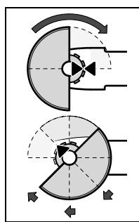
參考插圖把防護罩 12 安裝在主軸頸上。防護罩上的三角形記號，必須和機器傳動頭上的三角形記號相對。
