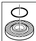
Di dalam flens untuk poros kerja 8 di sekitar titik sentral pemusatan ada satu bagian dari bahan sintetik (ring-O). Jika ring-O tidak ada atau rusak, flens untuk poros kerja 8 mutlak harus digantikan, sebelum Anda melanjutkan penggunaan perkakas.
