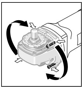
机器操作者可根据需要分段式转动机头，每一段的旋转角度为90度。此功能的优点是能够在特殊的工作状况下，把起停开关移动到比较容易操作的位置。例如切割时使用能够配合导引板的吸尘罩21，或者针对左撇子。
