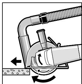
เครื่องต้องทำงานใน ทิศทางตรงขันมือกัน การหมุนเสมอ มีฉะนั้น จะเกิดอันตรายจาก การที่เครื่องถูกดันออก จำกอกรองตัดโดยความคุณ ไม่ได้
