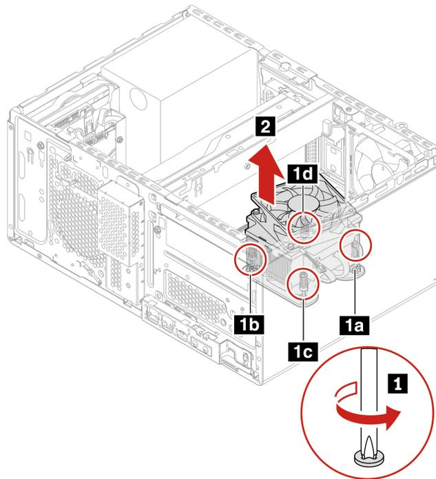
2. Posizionare l'assieme ventole e dissipatore di calore sulla scheda di sistema. Verificare che le quattro viti siano allineate ai fori sulla scheda di sistema. Seguire la sequenza riportata di seguito per stringere le quattro viti in modo da fissare il nuovo assieme ventole e dissipatore di calore. Non stringere eccessivamente le viti.
