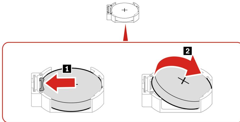
**Nota:** Dopo l'installazione di una nuova batteria in formato moneta, reimpostare la data e l'ora del sistema nel menu UEFI BIOS.
