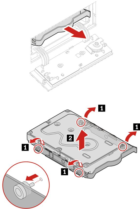
**Procedura di sostituzione dell'unità di memorizzazione da 2,5 pollici installata nell'enclosure di archiviazione ad accesso anteriore da 3,5 pollici**
