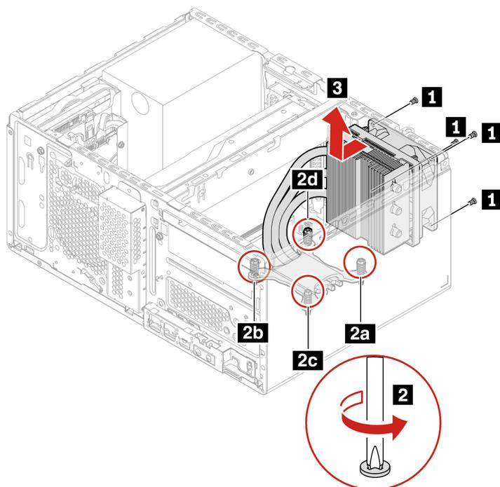
2. Posizionare il nuovo assieme ventole e dissipatore di calore sulla scheda di sistema. Verificare che le quattro viti siano allineate ai fori sulla scheda di sistema. Attenersi alla sequenza che segue per stringere le quattro viti e fissare il nuovo assieme ventole e dissipatore di calore alla scheda di sistema. Non stringere eccessivamente le viti. Installare quindi le quattro viti in modo da fissare il nuovo assieme ventole e dissipatore di calore allo chassis.
