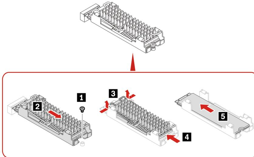
**Nota:** Quando si installa l'unità SSD M.2 e il dissipatore di calore, rimuovere la pellicola che copre il pad termico (se presente).
