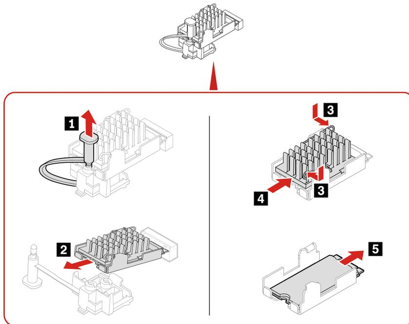
**Nota:** Rimuovere la pellicola che copre il pad termico (se presente), quando si installa l'unità SSD M.2 e il dissipatore di calore.
