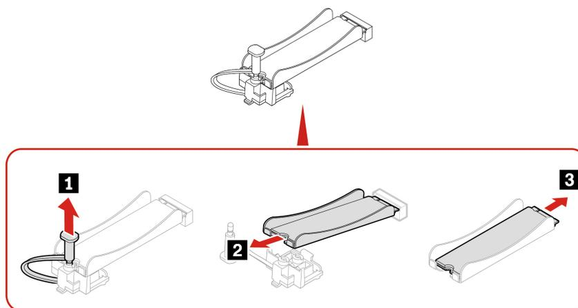
**Nota:** Rimuovere la pellicola che copre il pad termico (se presente), quando si installa l'unità SSD M.2 e il dissipatore di calore.
