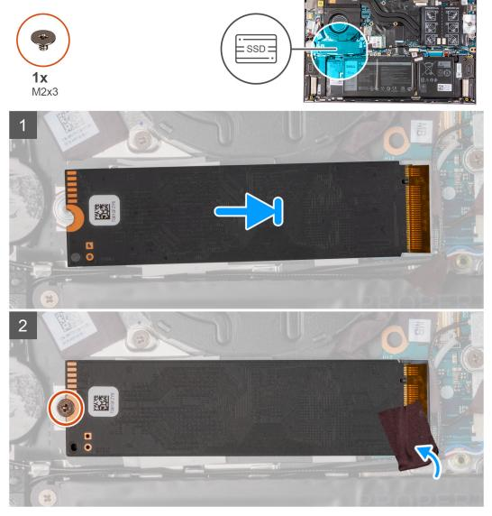
NOTA: Realice del paso 1 al paso 4 si va a reemplazar la unidad de estado sólido M.2 2230 con una unidad de estado sólido M.2 2280.
