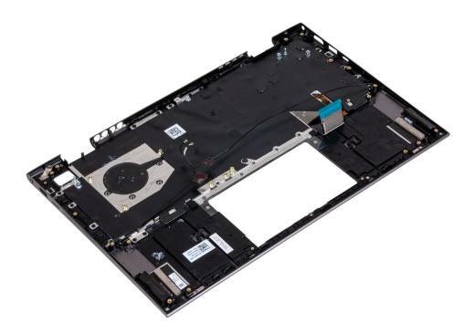
Después de realizar los pasos de los requisitos previos, queda el ensamblaje del teclado y el reposamanos.
