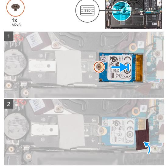
i) NOTA: Realice del paso 1 al paso 4 si va a reemplazar la unidad de estado sólido M.2 2230 con una unidad de estado sólido M.2 2280.
