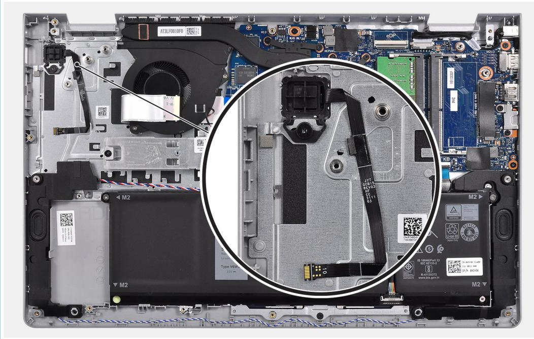
3. Vuelva a adherir la cinta para fijar el FPC del lector de huellas digitales al ensamblaje del teclado y del reposamanos.
