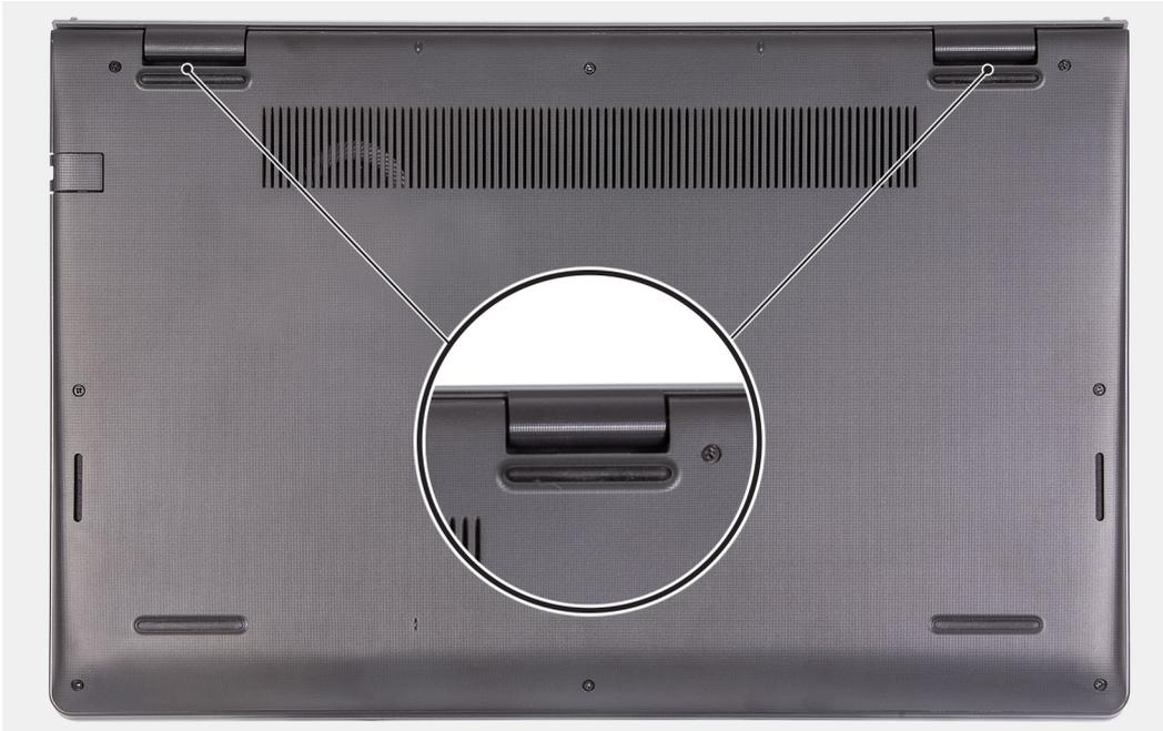
4. Levante y deslice la cubierta de la base para quitarla del ensamblaje del teclado y el reposamanos.
