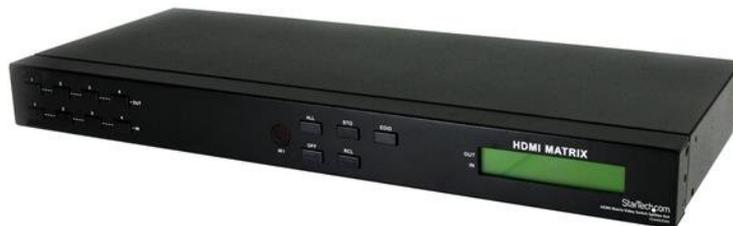
El Conmutador/ Divisor de Video/Audio HDMI Matrix 4x4 (con Audio y RS232), VS440HDM permite compartir hasta 4 entradas HDMI o DVI (con adaptadores HDMI a DVI - no incluidos) diferentes, con su audio correspondiente, entre 4 pantallas o proyectores independientes.
