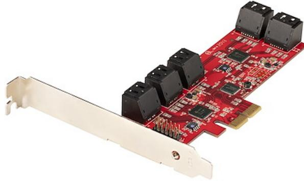
Este controlador de 10 puertos SATA III (6Gbps) le permite añadir 10 unidades de disco duro (HDD) SATA de 6Gbps o unidades de estado sólido (SSD) a su sistema informático o servidor a través de una ranura de tarjeta PCIe x2 disponible. La tarjeta es compatible con las especificaciones SATA III y PCI-Express 2.0.
