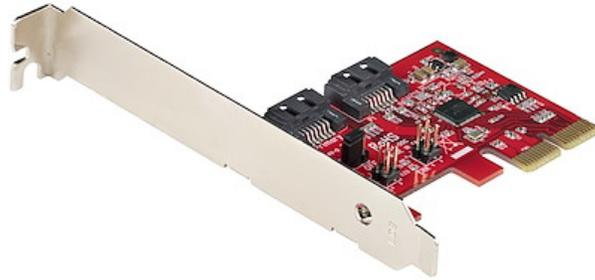
Ce contrôleur SATA III (6Gbps) à 2 ports avec RAID vous permet d'ajouter deux disques durs (HDD) ou disques durs solides (SSD) SATA 6Gbps à votre système informatique ou serveur via un emplacement de carte PCIe x2 disponible, et de construire les disques dans une matrice RAID matérielle. La carte prend en charge les spécifications SATA III et PCI-Express 2.0, et peut également être utilisée pour ajouter des lecteurs de disques optiques (ODD) tels que les CD/DVD/Blu-ray à votre ordinateur.
