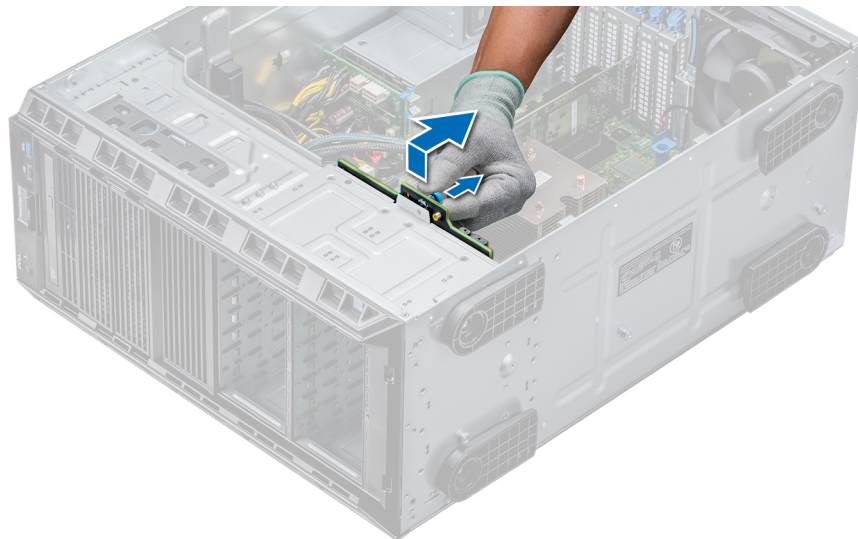
Figure 50. Retrait d'un fond de panier
