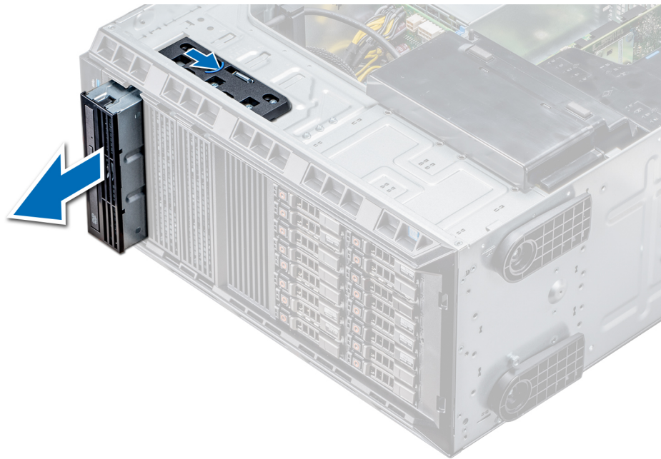
Figure 39. Retrait du bâti du lecteur optique ou du lecteur de bande
