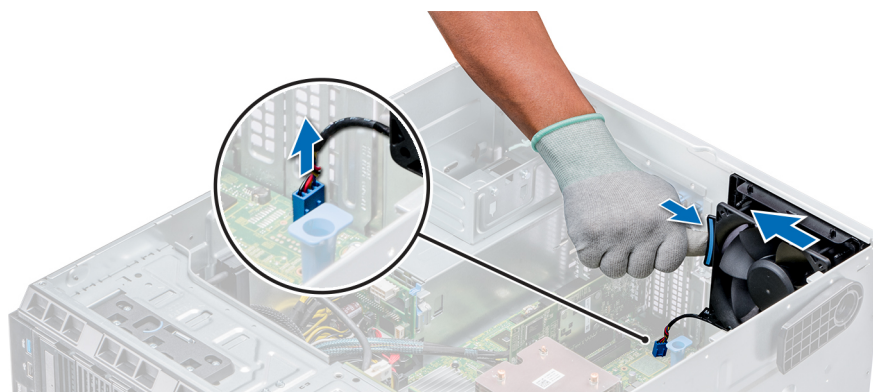
Figure 55. Retrait du ventilateur de refroidissement interne
