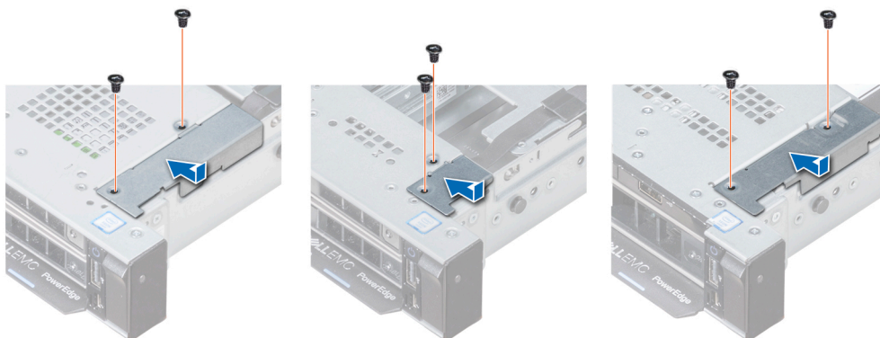
Ilustración 111. Instalación de la cubierta de cables
