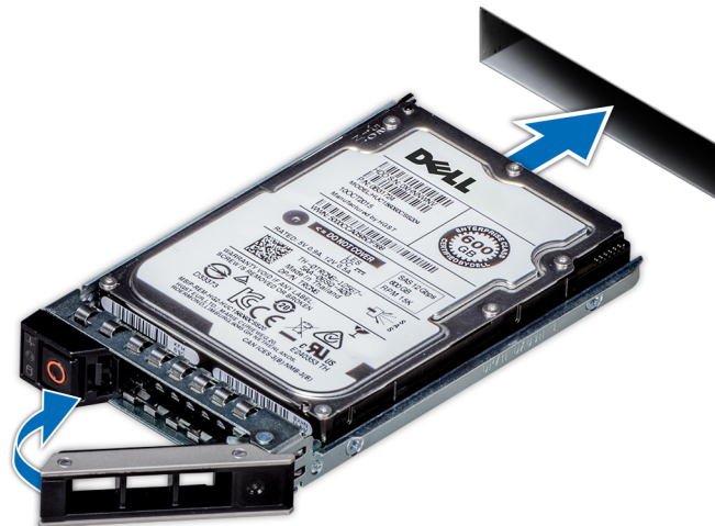
Ilustración 36. Instalación de una unidad de disco duro
