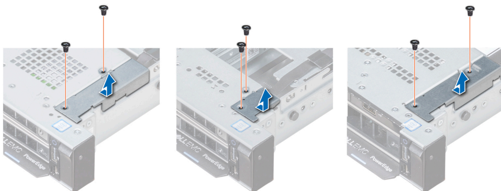
Ilustración 109. Extracción de la cubierta de cables
