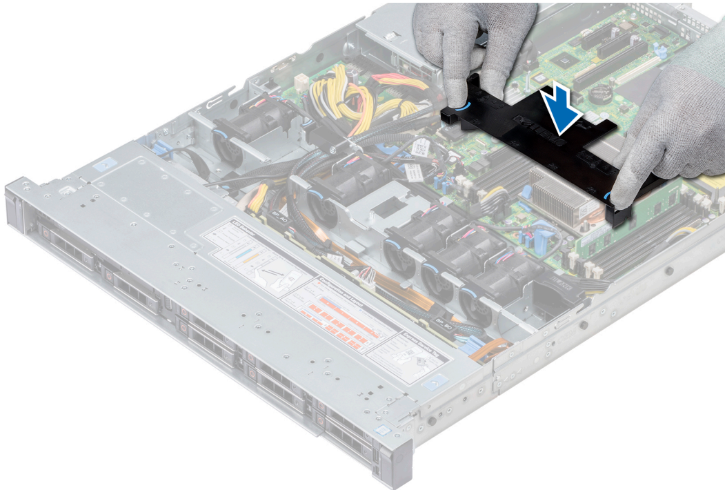
Ilustración 24. Instalación de la cubierta para flujo de aire
