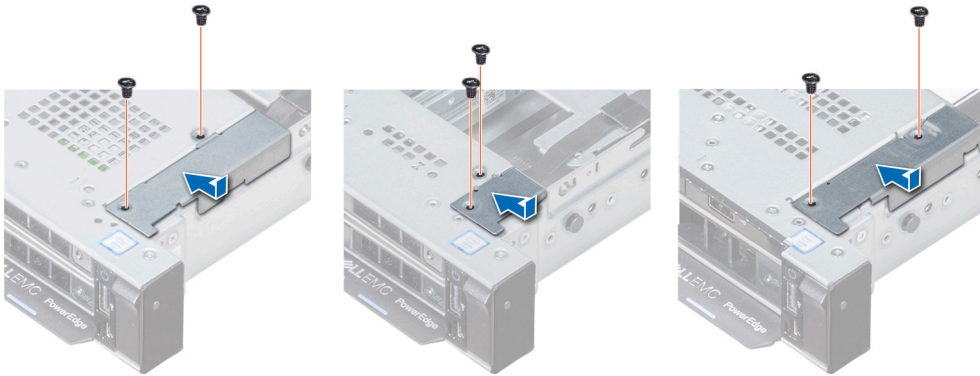
Ilustración 126. Instalación de la cubierta de cables
