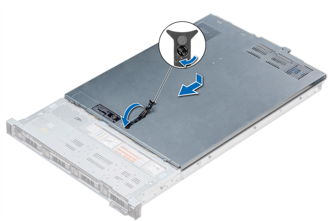
Ilustración 22. Instalación de la cubierta del sistema
