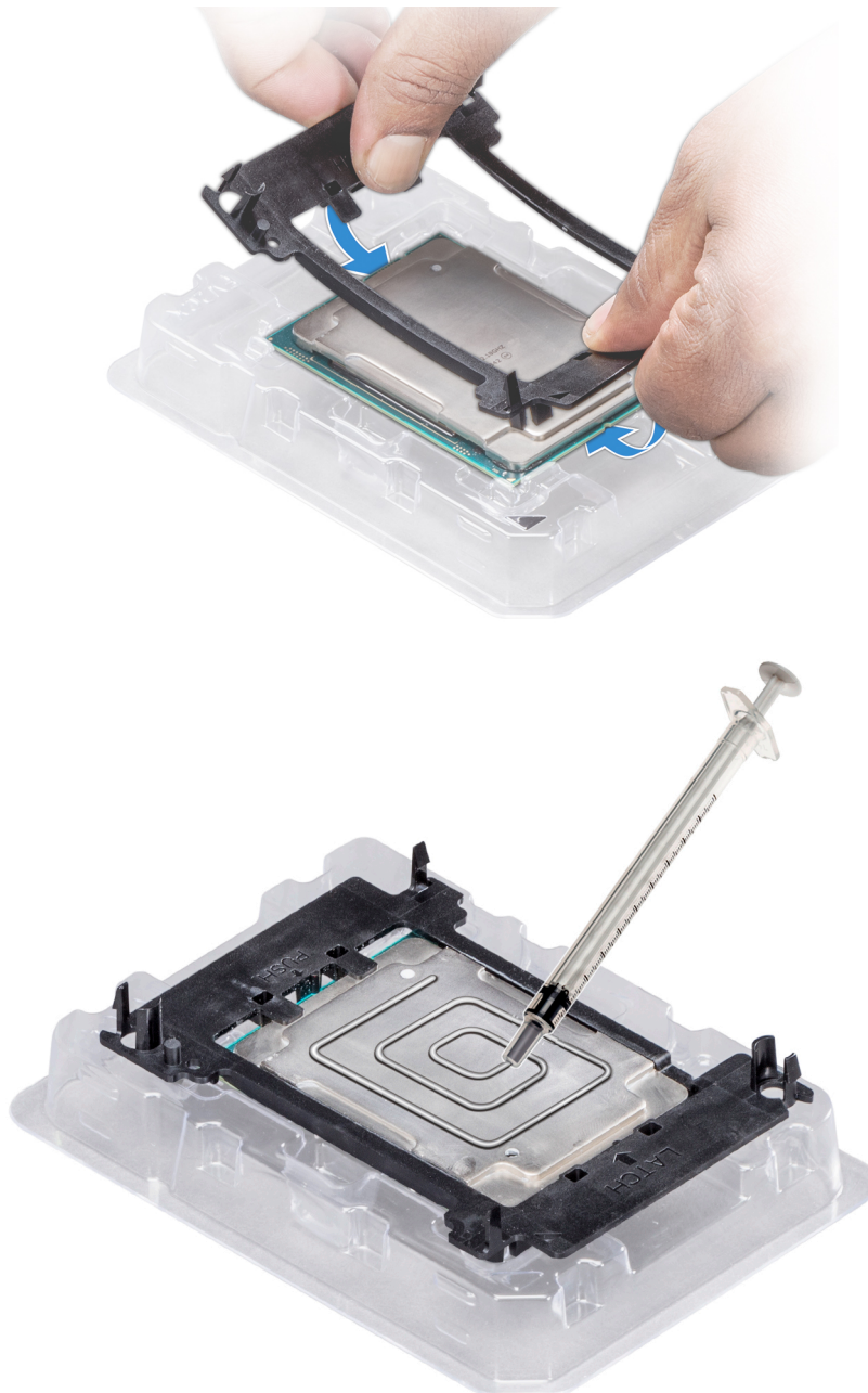
Ilustración 47. Aplicación de la pasta térmica en la parte superior del procesador
