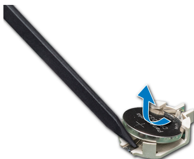
Figure 104. Retrait de la pile du système
