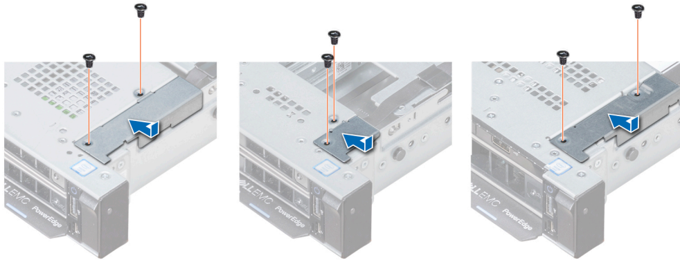
Figure 126. Installation du cache-câbles
