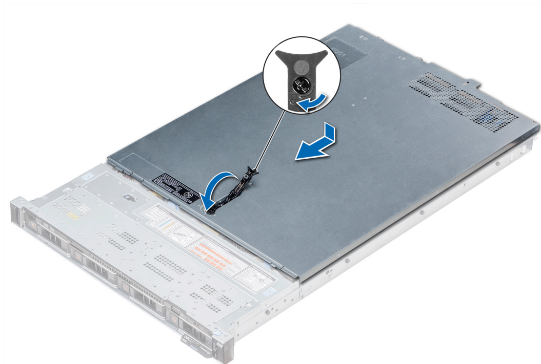
Figure 22. Installation du capot du système
