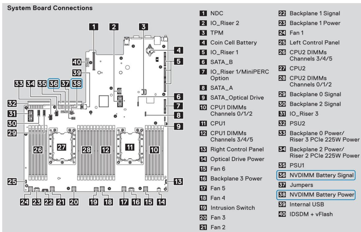
**Abbildung 8. Systemplattenanschlüsse beim R740/R740XD**
