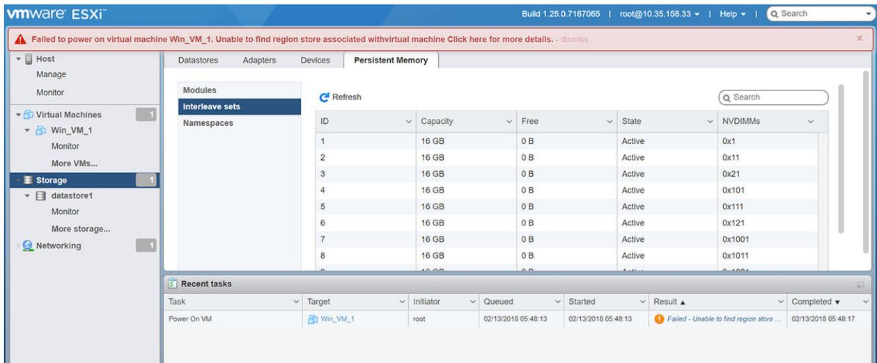
Abbildung 37. NVDIMM-N-Fehler
