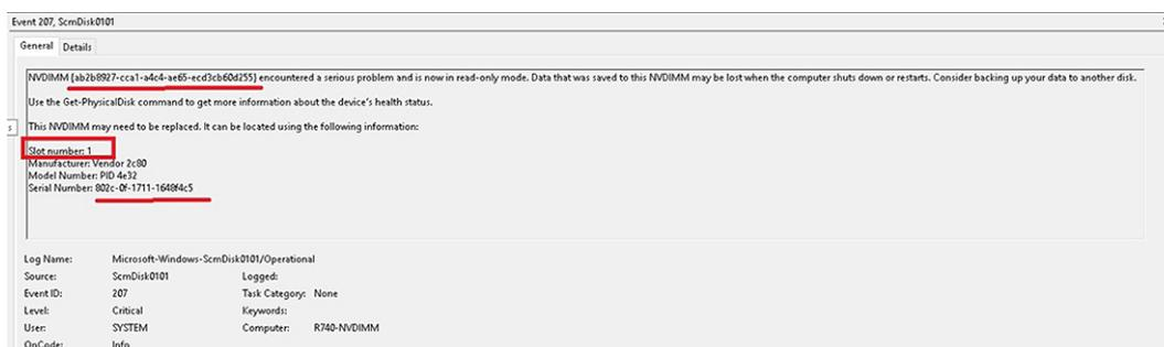
Abbildung 23. Protokollierungsinformationen für Betrieb und Diagnose: NVDIMM-N Festplatte
