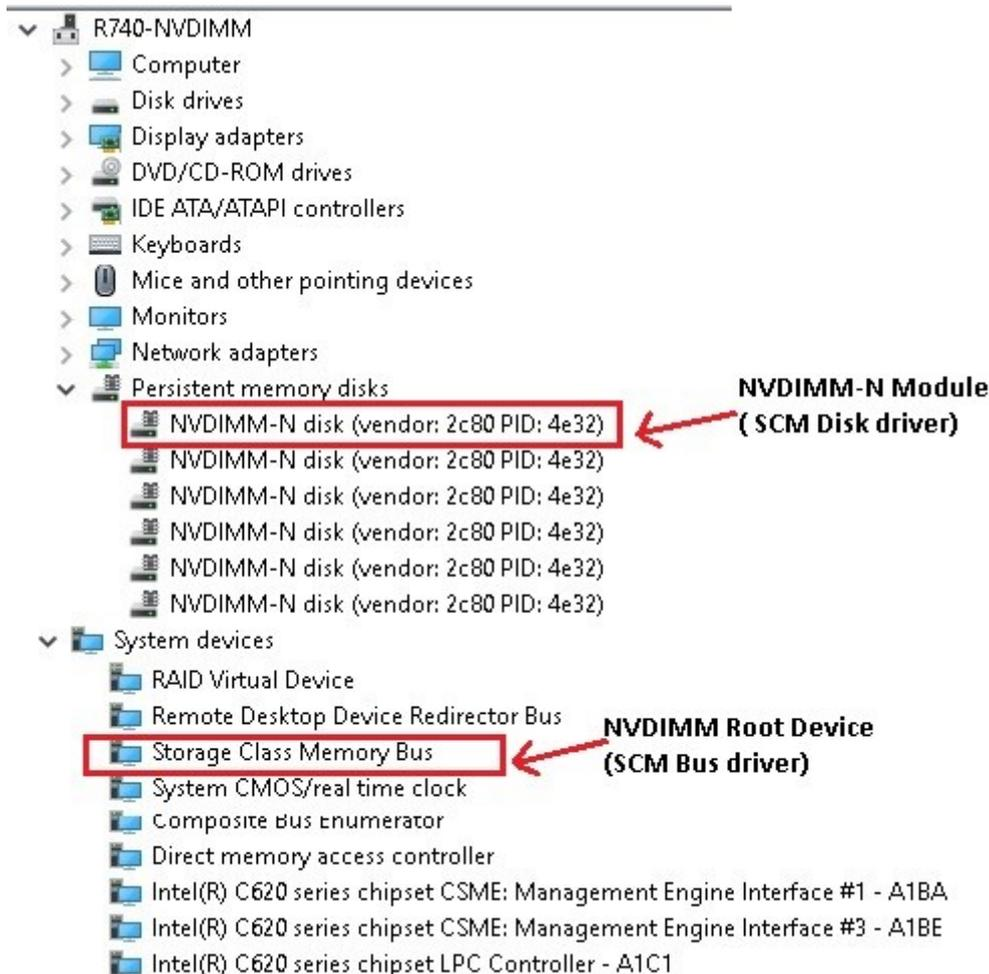
Abbildung 18. Windows Gerätemanager-Ansicht von NVDIMM-N-root-Gerät und NVDIMM-N-Festplatteninstanzen
