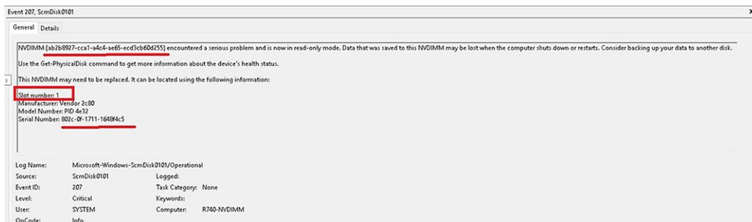
Figure 23. Informations de journalisation des opérations et des diagnostics : disque NVDIMM-N
