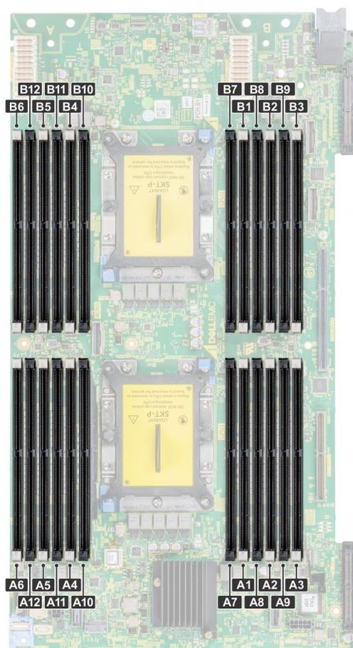
**Figure 6. Disposition de la mémoire MX740c**
