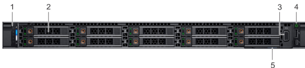
Figure 4. Vue avant d'un système à 10 disques de 2,5 pouces
