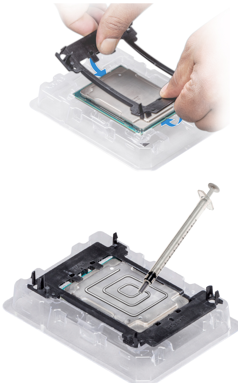
Figure 47. Application de graisse thermique sur la partie supérieure du processeur
