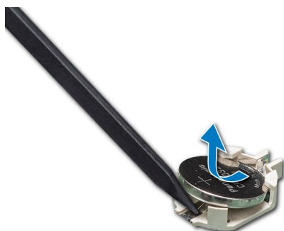
Figure 104. Retrait de la pile du système
