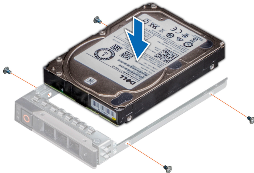
Figure 28. Installation d'un disque dans un support de disque
