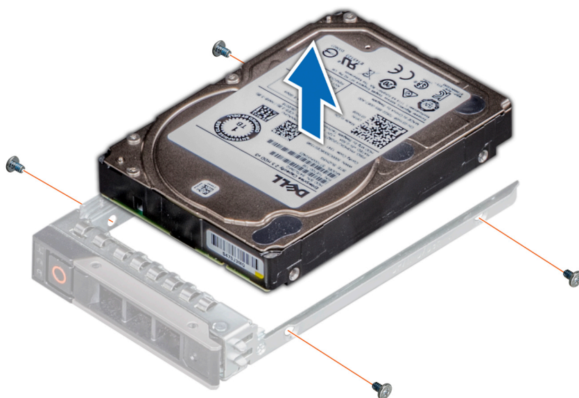
Figure 27. Retrait d'un disque dur installé de son support
