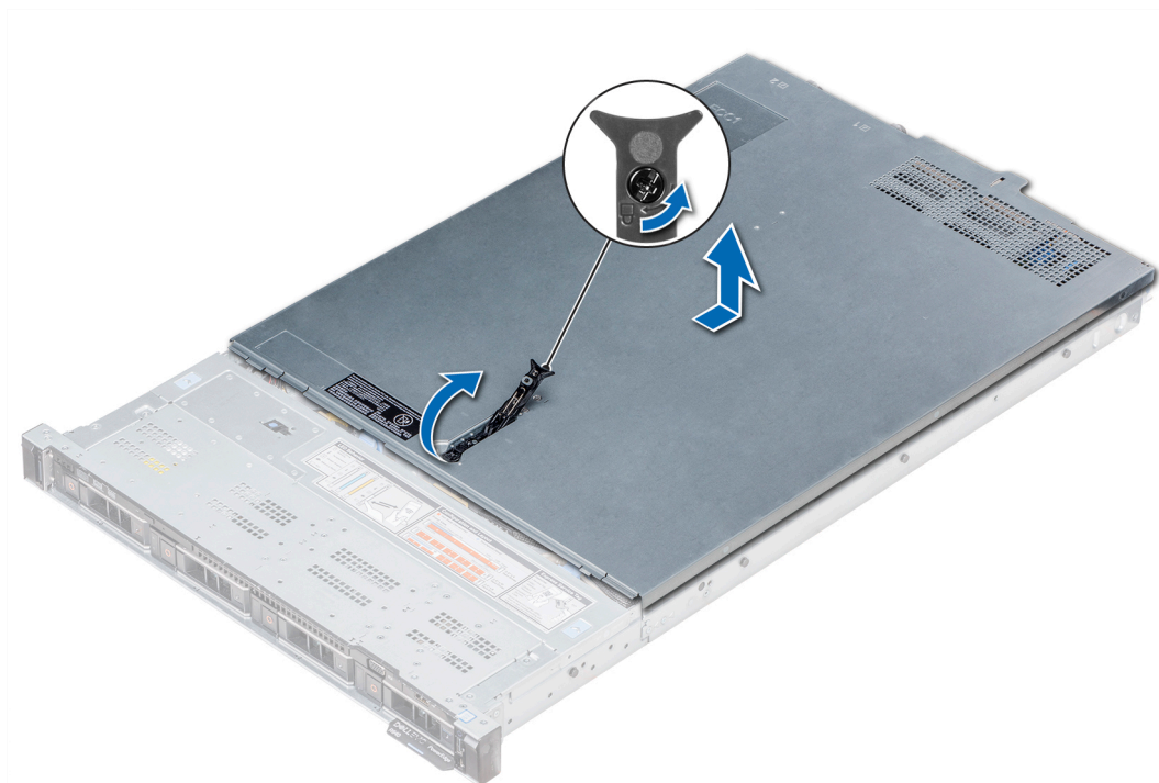
Figure 21. Retrait du capot du système
