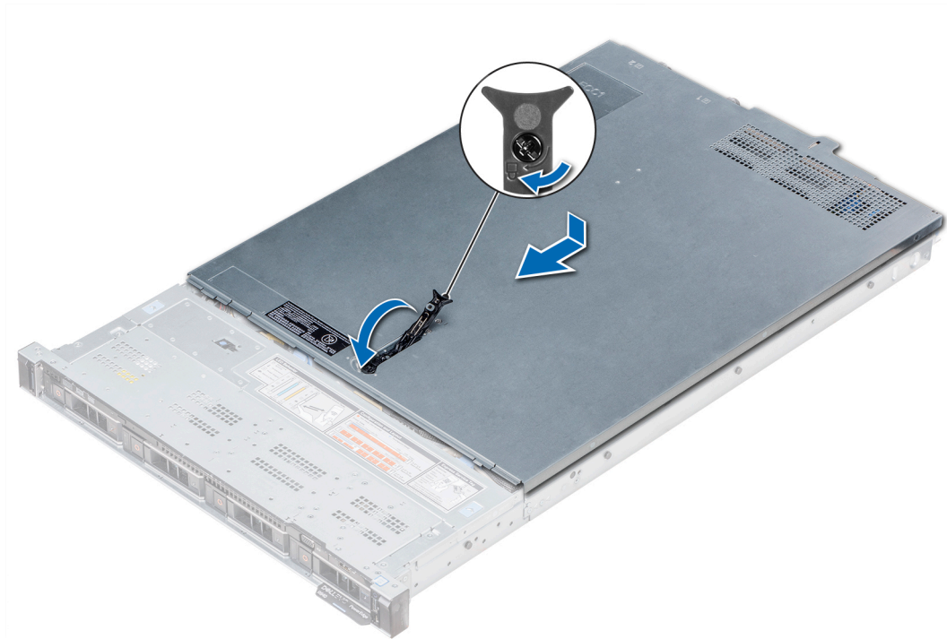
Figure 22. Installation du capot du système
