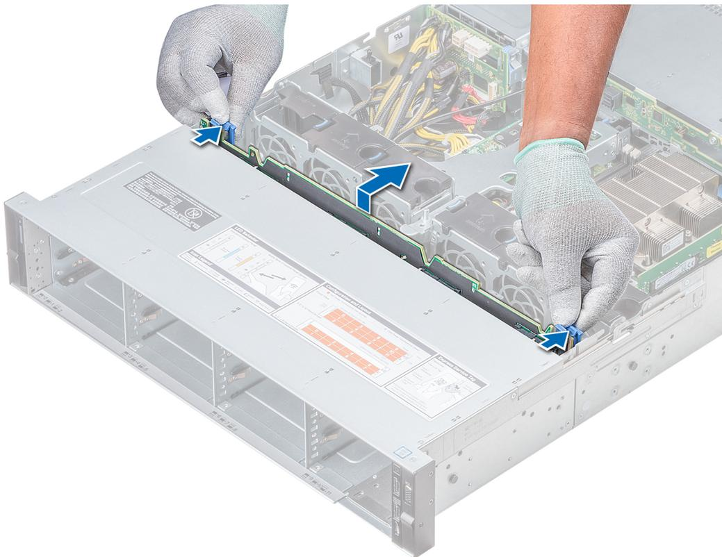
Abbildung 100. Entfernen der Rückwandplatine
