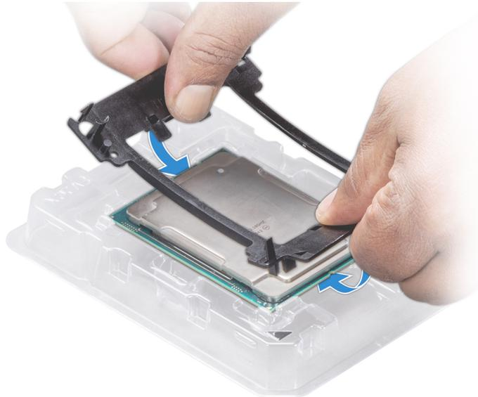
**Abbildung 60. Installieren der Prozessor-Halterung**
