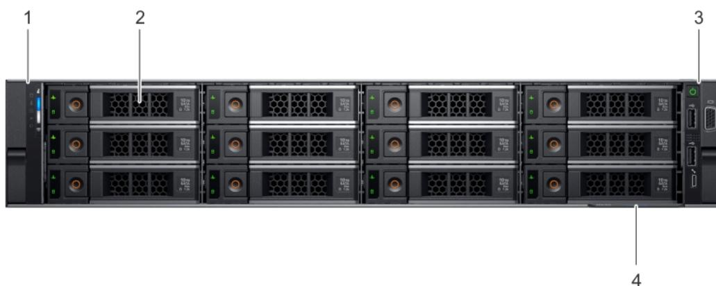
Abbildung 2. Vorderansicht eines Systems mit 12 x 3,5-Zoll-Laufwerksystemen
