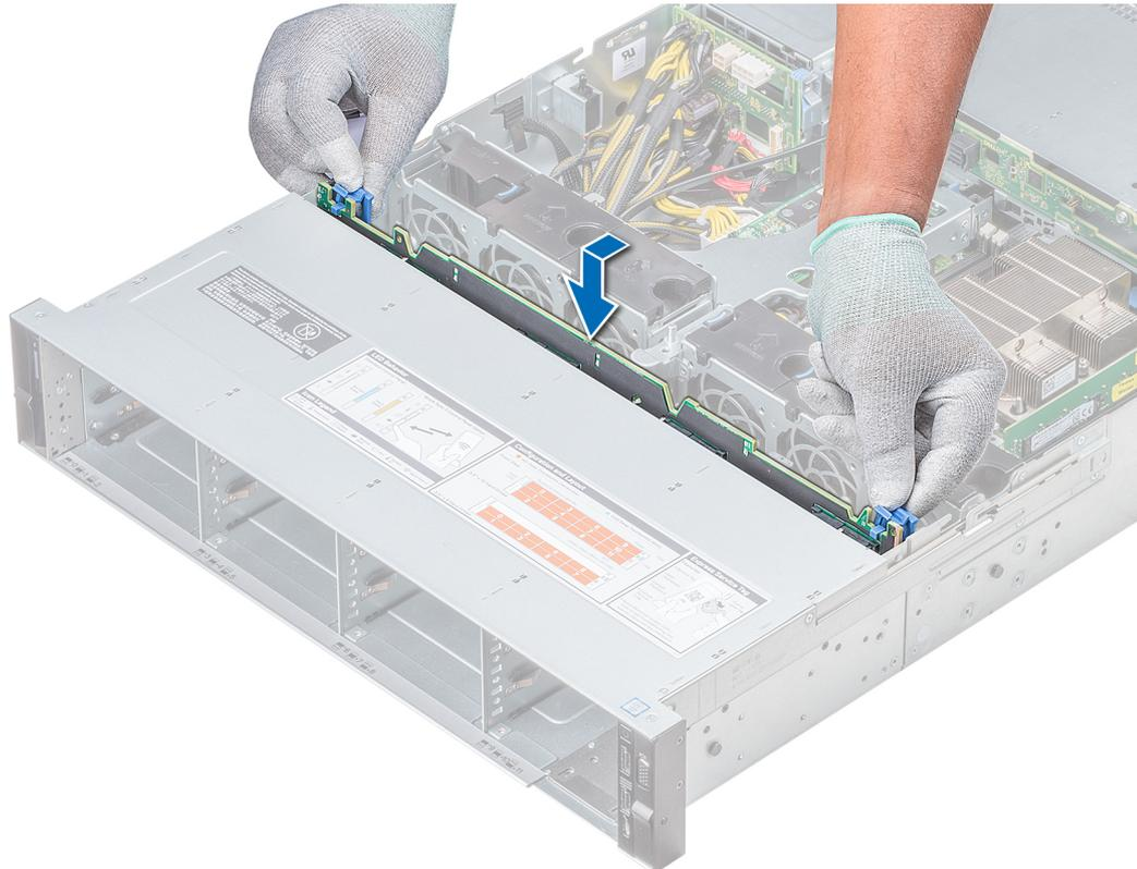
Abbildung 101. Installieren der Rückwandplatine
