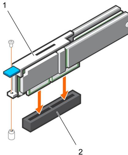
**Figure 10. Installation de la carte modulaire BOSS-S1**
