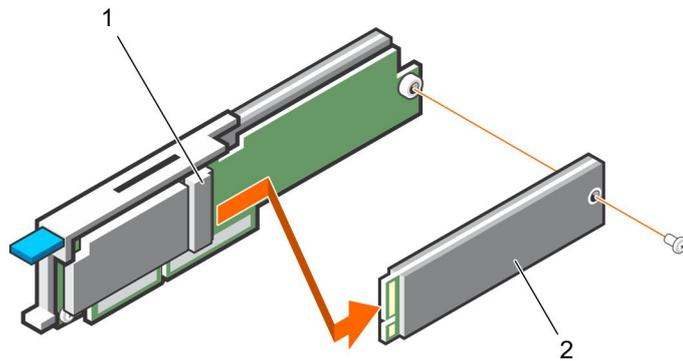
**Figure 6. Retrait du module M.2 SSD de la carte modulaire BOSS-S1**
