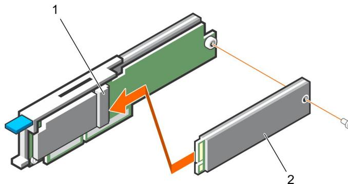
Figure 8. Installation du module M.2 SSD sur la carte modulaire BOSS-S1
