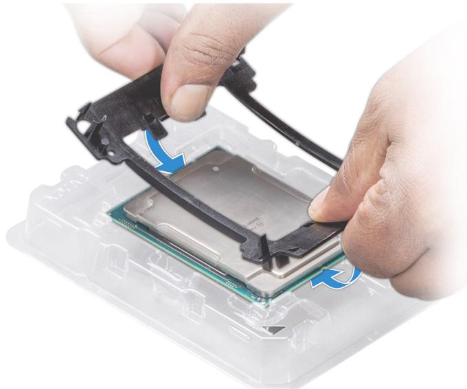
Figure 60. Installation du support de processeur
