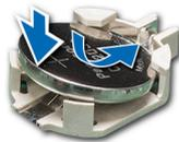
Figure 112. Installation de la pile du système
