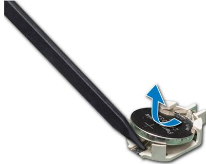
Figure 111. Retrait de la pile du système
