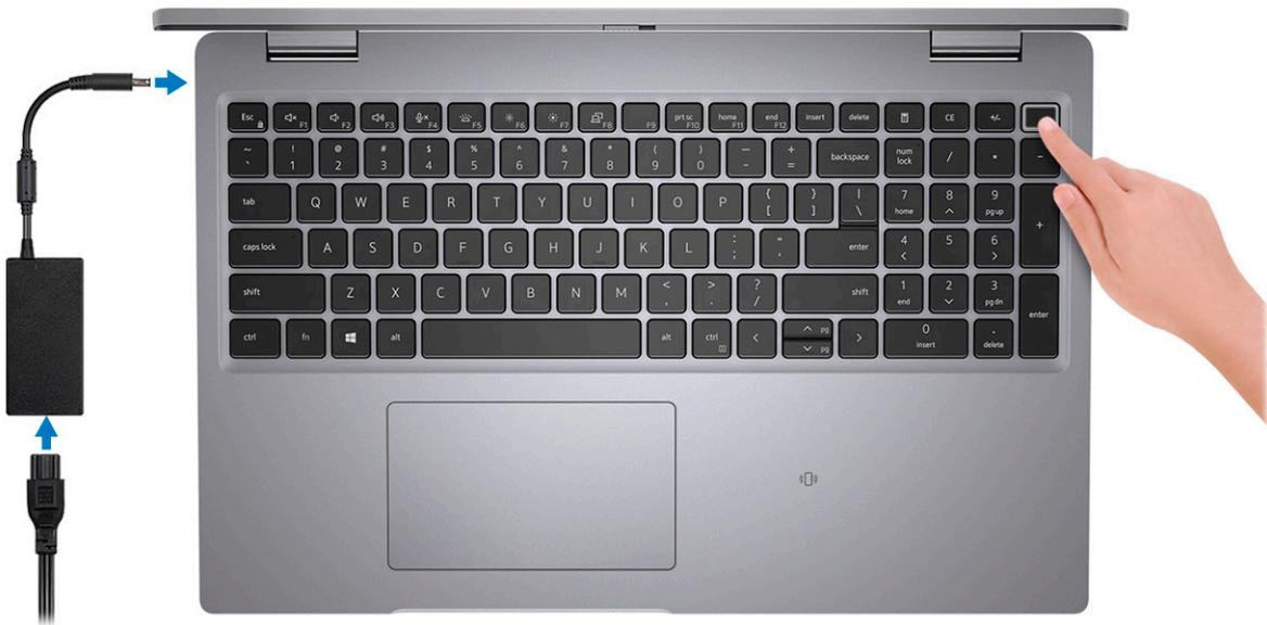
**ANMERKUNG:** Der Akku kann während des Versands in den Energiesparmodus wechseln, um den Akku nicht zu entladen. Stellen Sie sicher, dass der Netzadapter an den Computer angeschlossen ist, wenn er zum ersten Mal eingeschaltet wird.
