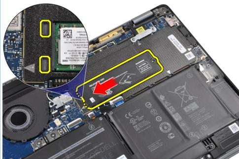
Setzen Sie die SSD-Kühlplatte auf der Oberseite des SSD-Laufwerks ein und befestigen Sie sie mithilfe der einzelnen Schraube (M2x2) an der Systemplatine.
