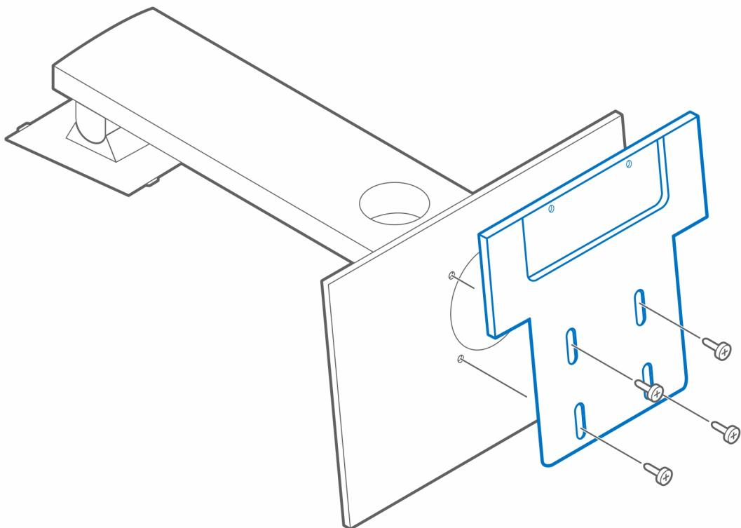
4. Coloque el montaje VESA para la base de monitor de Dell en el sistema.
