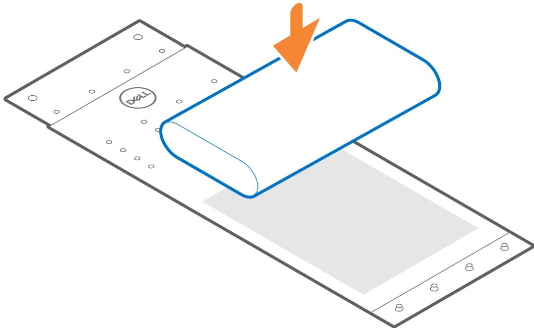
3. Ajuste la funda alrededor del adaptador de CA e inserte las lengüetas de retención en los orificios en el nivel apropiado.
