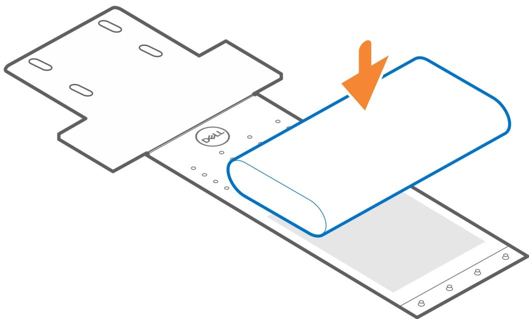
5. Ajuste la funda alrededor del adaptador de CA e inserte las lengüetas de retención en los orificios en el nivel apropiado.
