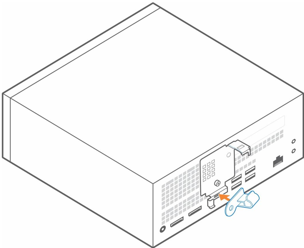
6. Vuelva a colocar el clip inclinado hacia la izquierda de forma horizontal y encájelo en la cubierta de cables.
