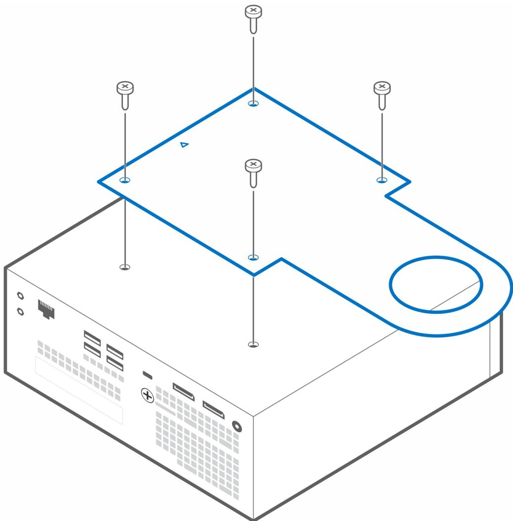
6. Alinee la ranura del montaje VESA para la base de monitor de Dell con la ranura de manejo de cables en la base de monitor de Dell.
