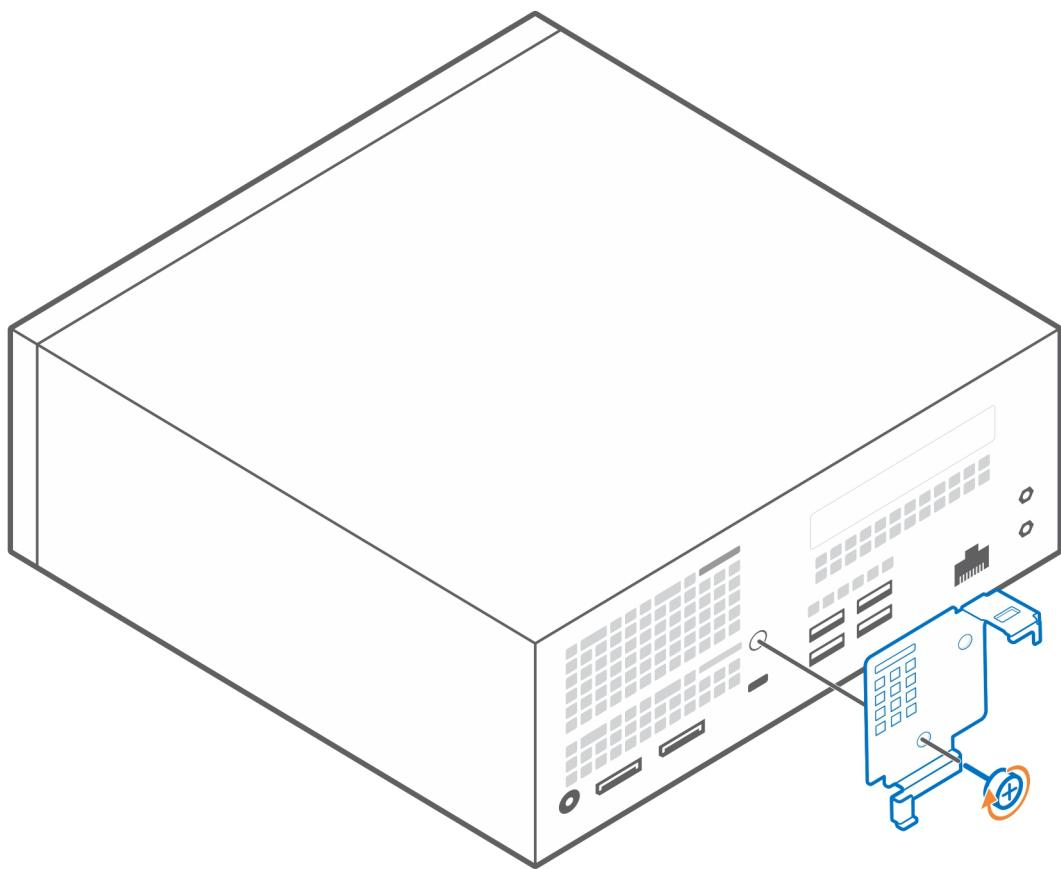
5. Inserte el gancho en el orificio de la cubierta de cables e inclínelo diagonalmente hacia la izquierda.
