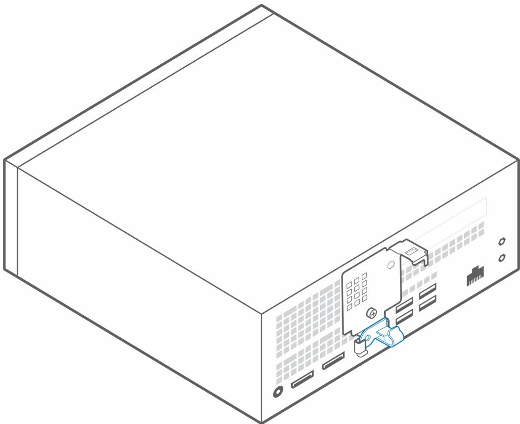
7. Alinee la cubierta de cables con los ganchos de retención en las ranuras del chasis de Dell Precision 3240 Compact.
