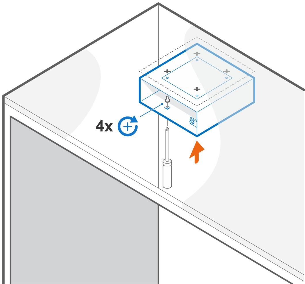
4. Deslice el sistema dentro del montaje de funda VESA.
